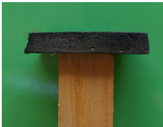
Figura 49 – Detalhe da chapa de borracha.
