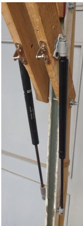
Figura 36 - Dois Pistões Instalados
