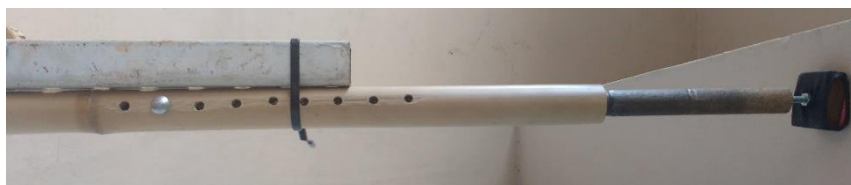
Figura 22 - Pino Passante no Bambu.
