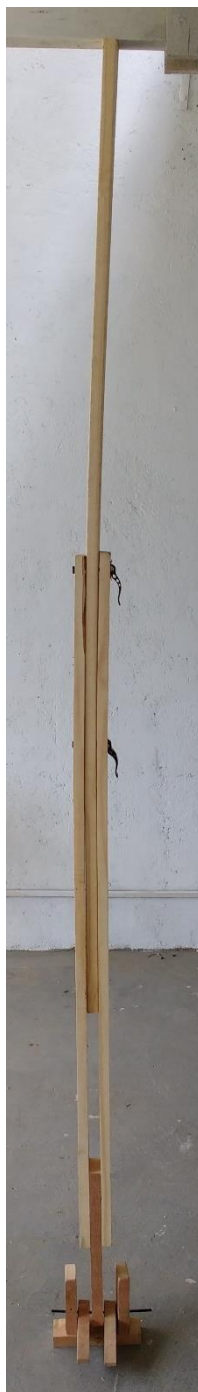
Figura 46 – Flambagem da estrutura.
