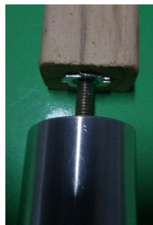
b/ Detalhe do pino roscado.
