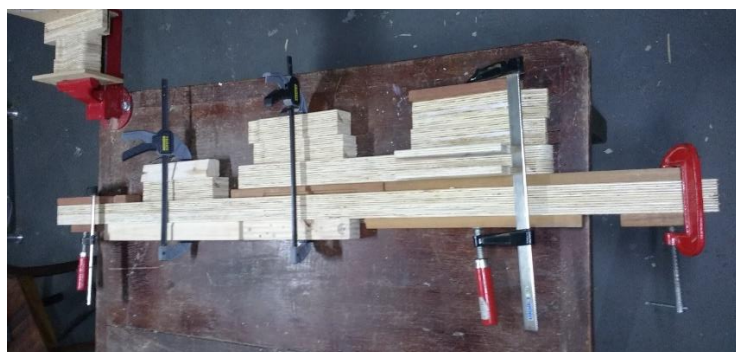
Figura 97 - Colagem de Componentes
