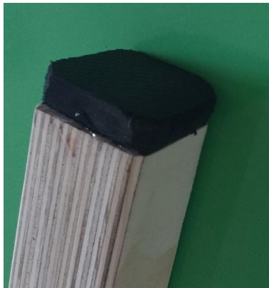
Figura 111 - Elastômero do topo da haste central.
