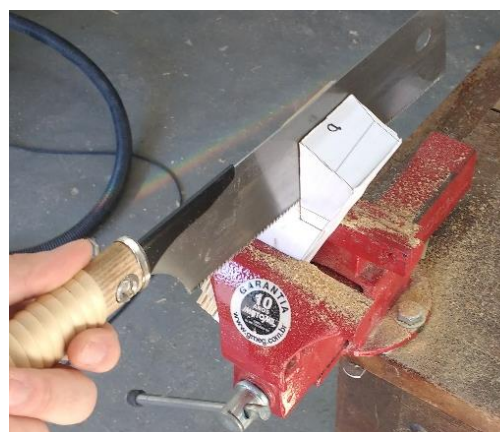
b/ Corte angulado do componente.
