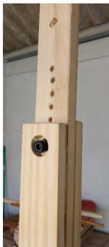
a/ Detalhe Padrão Linear de Furos.
