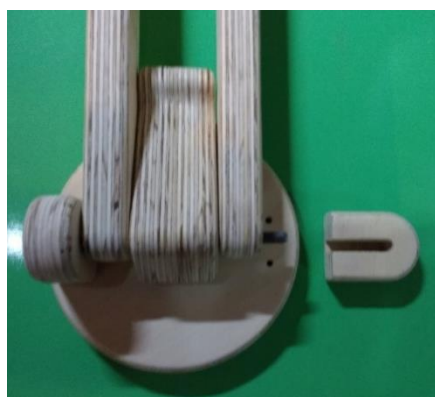
b/ Inserção do eixo principal.
