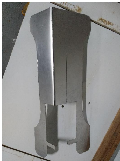
d/ Chapa dobrada – vista superior.
