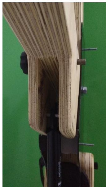
d/ Detalhe do encaixe do pistão.
