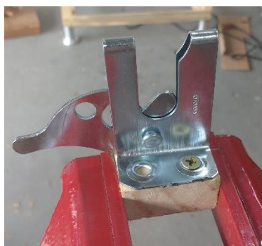
a/ Detalhe do fecho “papagaio”.
