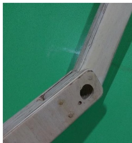
d/ Detalhe do furo para alça.
