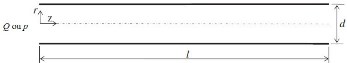
Figura 2 - Geometria utilizada para simular o problema de reinício do escoamento (Adaptado de Oliveira e Negrão, 2015).
