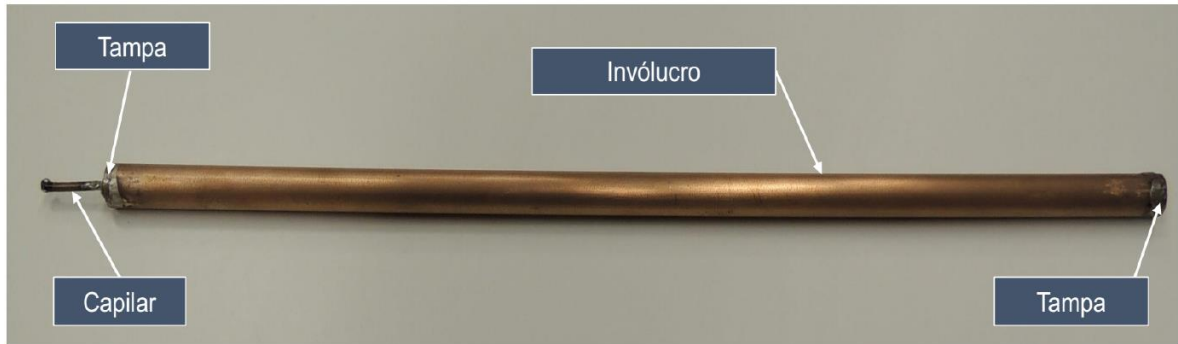
Figura 21 Componentes do termossifão confeccionado
