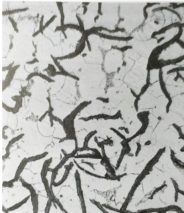
Figura 7 – Microscopia óptica típica de ferro fundido cinzento.
