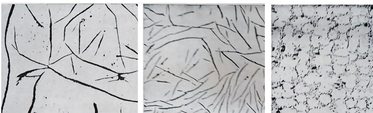
Figura 5 - Exemplos dos tamanhos de grafita em FOFO cinzento, respectivamente: (a) tamanho 1, (b) tamanho 3, (c) tamanho 8.
