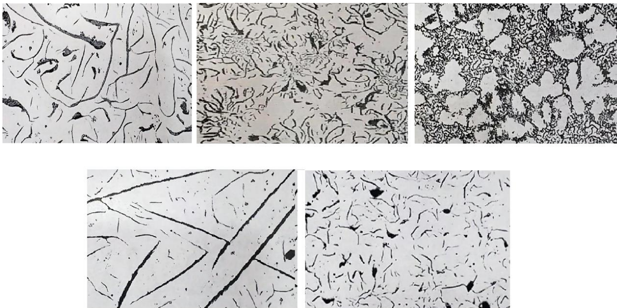
Figura 4 - Exemplos dos tipos de grafita: Respectivamente (A), (B), (C), (D), (E).
