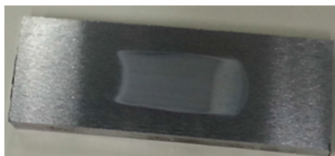
Figura 23 – Corpo de prova após ensaio de desgaste abrasivo. Fonte: Autoria própria
