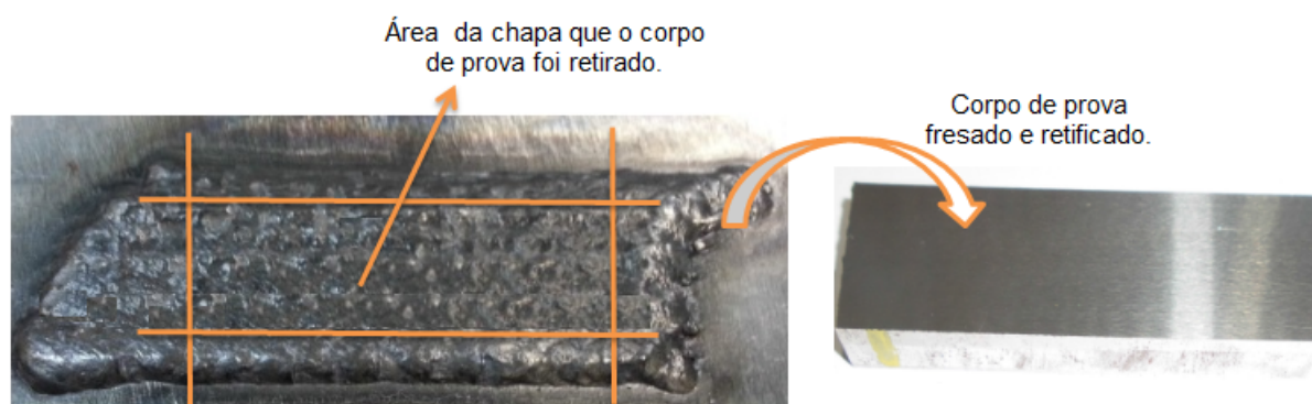
Figura 21 – Representação das etapas de preparação dos Corpos de prova conforme recomendação da norma (ASTM, 2001)[G65 01]. Fonte: Autoria própria
