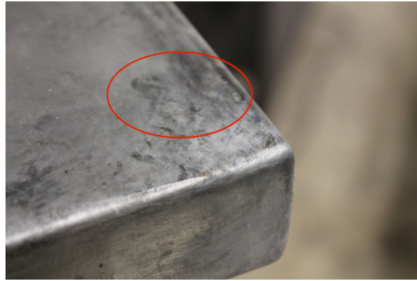
Figura 2.6 – Peça galvanizada com manchas provocadas por impurezas.
