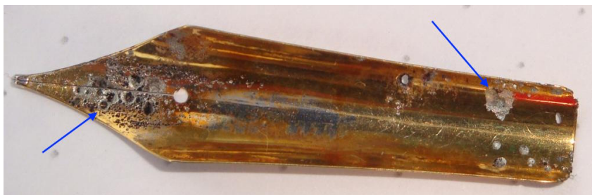
Figura 2.1 – Exemplo de peça com corrosão catódica.
