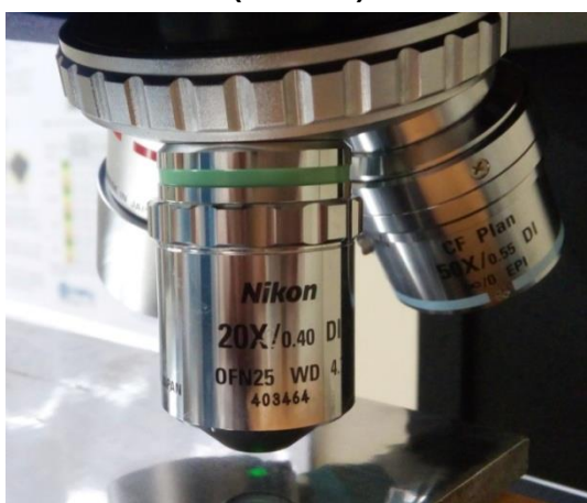
Figura 20: Detalhe da lente do interferômetro utilizada para medição das rugosidades 2D e 3D e seu feixe sobre a amostra
