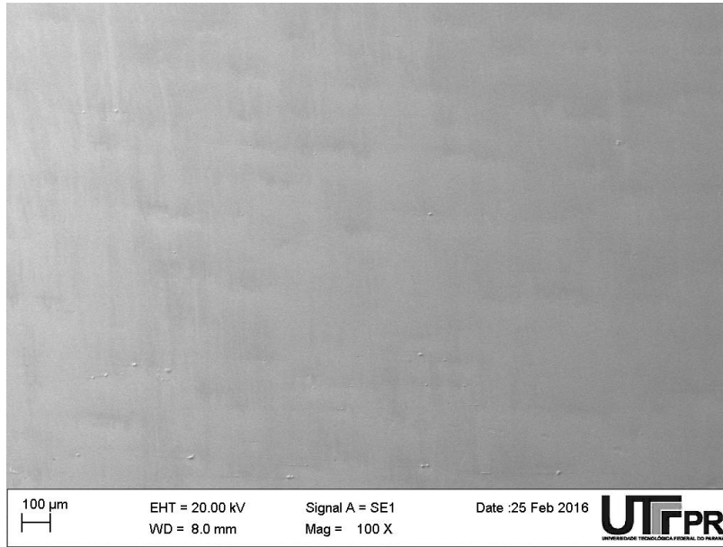
Figura 40: Micrografia via MEV de superfície polida Fonte: MEV
