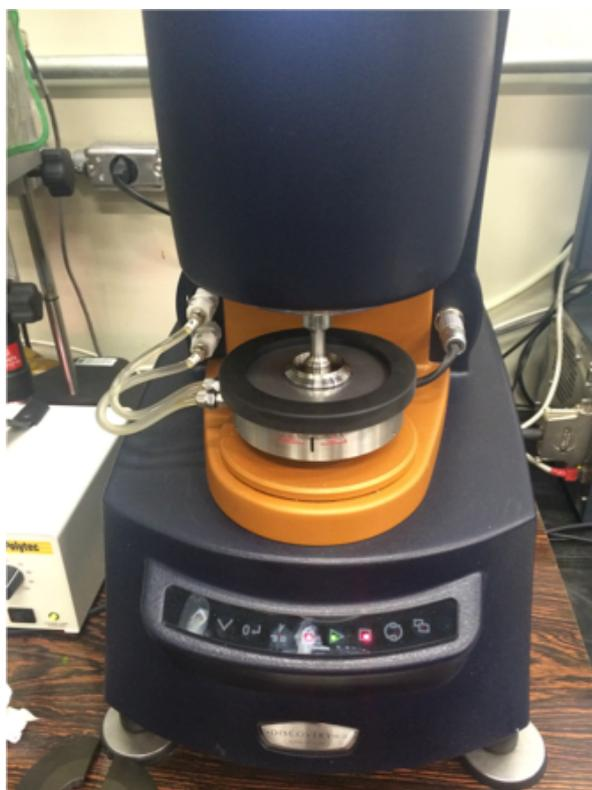
Figura 15 - Reômetro DHR-3 híbrido utilizado para o ensaio reométrico.
