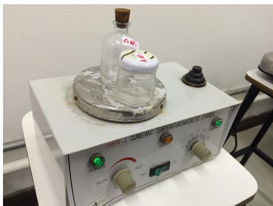
Figura 13 - Agitador magnético.
