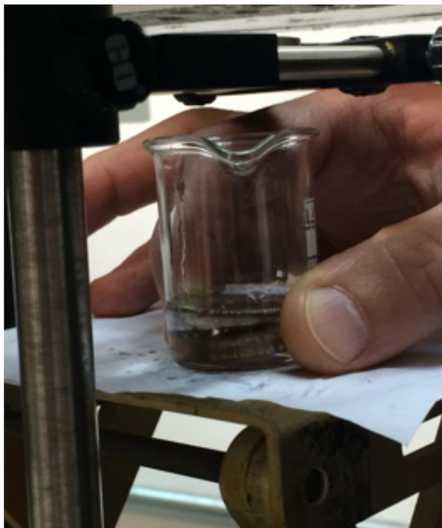
**Figura 17 - LASiS - é possível observar a coluna de solvente acima do alvo.**
