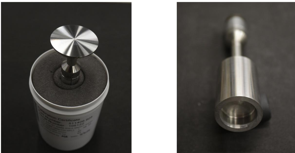
Figura 16 - Geometria de teste (a) Cônica e (b) Cilíndrica.
