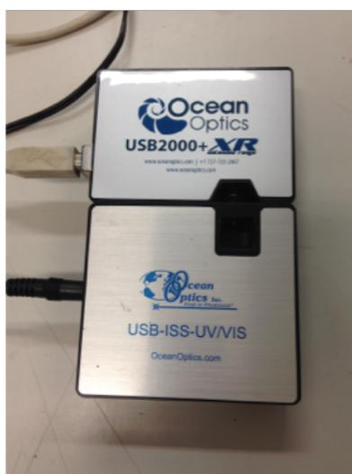
Figura 12 - Espectrômetro Óptico.
