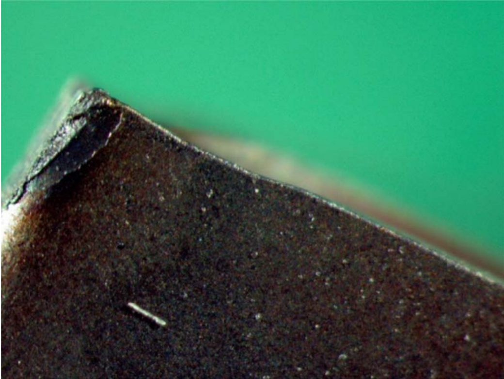
Figura 8 – Ferramenta colapsada em 60 segundo com velocidade de corte a 133 m/min utilizando fluido de corte.
