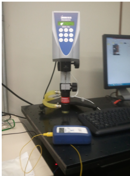
Figura 21 - Viscosímetro Brookfield DV-II+ Pro.
