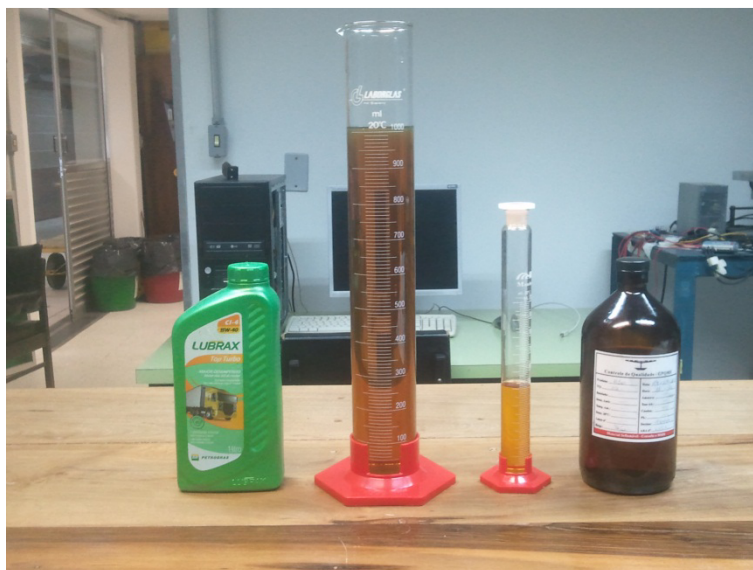
Figura 24 - Materiais utilizados para o procedimento de mistura. À esquerda, o lubrificante; em seguida, as provetas de 1 litro e de 100 ml; e à direita o recipiente contendo o biodiesel.
