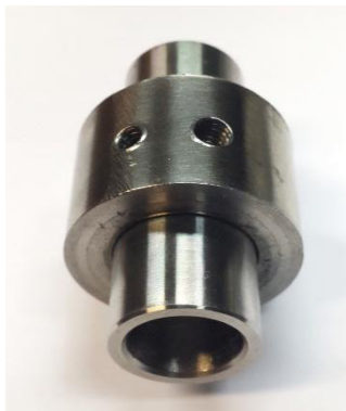
Figura 20 - Par tribológico utilizado para a realização dos ensaios.
