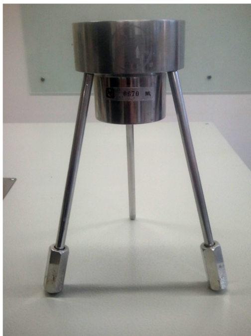
Figura 23 - Copo Ford montado com o orifício nº4.
