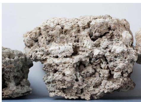
Figura 1 – Fragmentos de rochas carbonáticas microbianas presentes nas reservas de petróleo da camada pré-sal.
