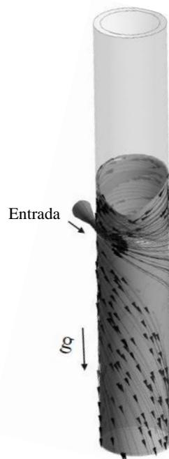
**Figura 2.5 - Visualização em ângulo das linhas de corrente do escoamento entrando na câmara de expansão do separador VASPS.
