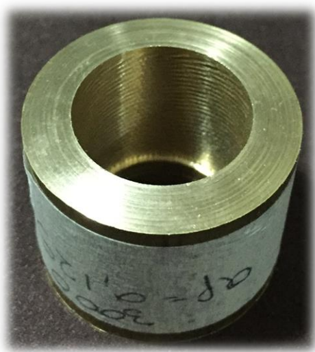
Figura 31 - Acabamento superficial na usinagem a 3000 rpm e ap=0,125 mm
