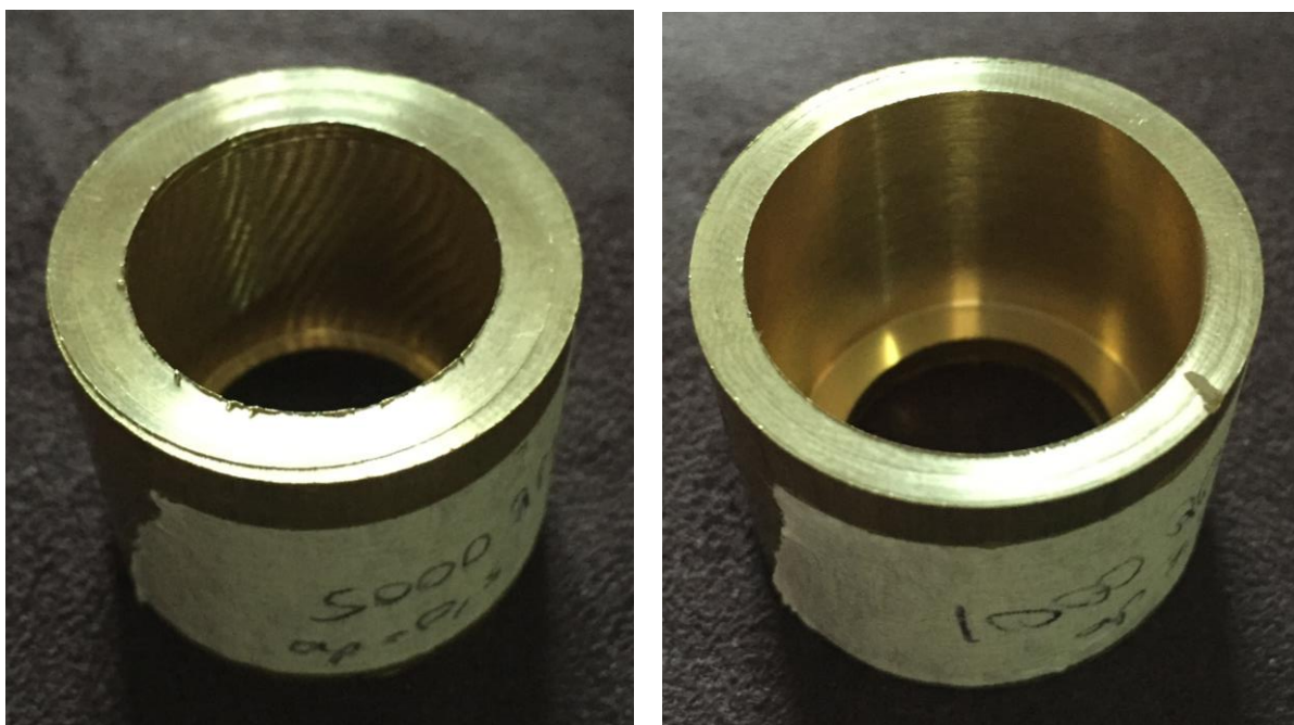
Figura 24 - Acabamento superficial para processos à 5000 e 1000 rpm, respectivamente
