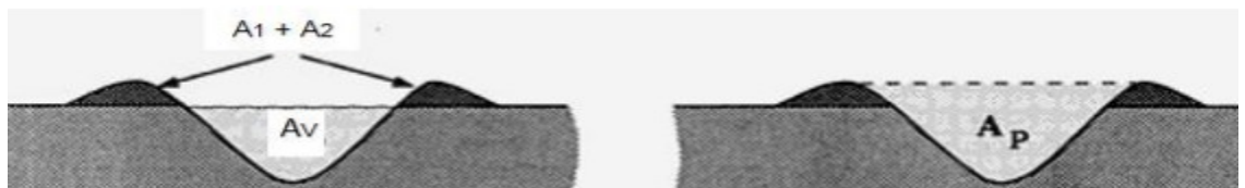
Figura 8 - Esquema da seção transversal do sulco formado
