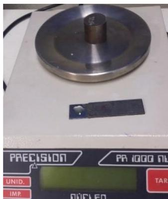
**Figura 28 – Amostra de gabarito com a quantidade correta de adesivo a ser colocada na amostra do tipo 1**
