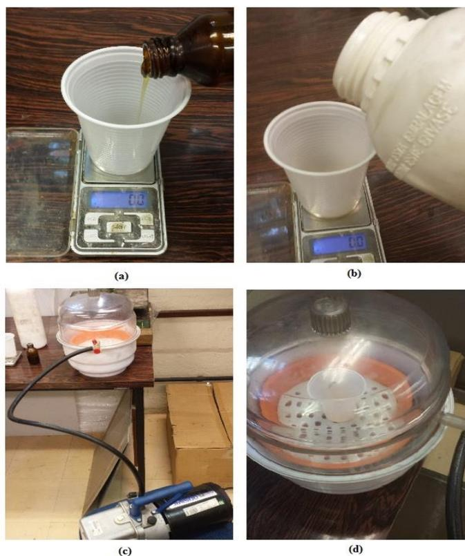
**Figura 21 – Processo de preparo da PU. (a) adição do pré-polímero (b) adição do polioli (c) conjunto dessecador/bomba de vácuo (d) dessecador com o adesivo**
