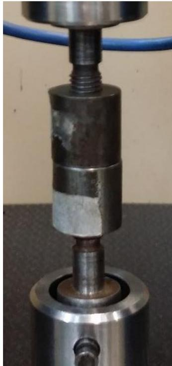
**Figura 27 – Suporte para o ensaio de tração**
