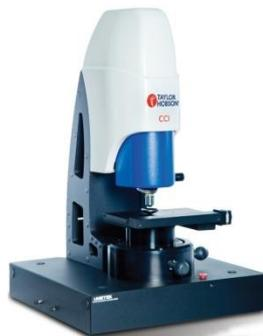
**Figura 20 – Rugosímetro 3DTalysurf CCI**
