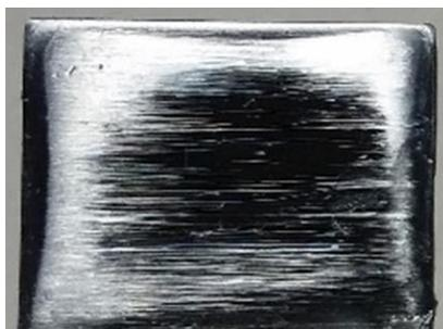
**Figura 25 – Diferença de acabamento em uma mesma peça**
