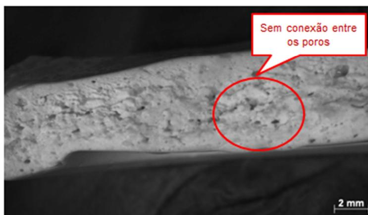
**Figura 22 – Secção transversal de espuma com poros não conectados**
