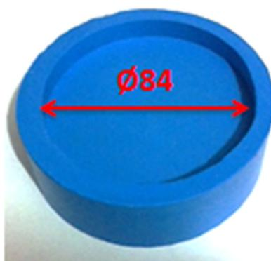
Figura 15 – Molde de silicone para produção das espumas
