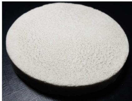
**Figura 27 – Espuma com proporção volumétrica uma parte de resina para 0,75 partes de emulsão**
