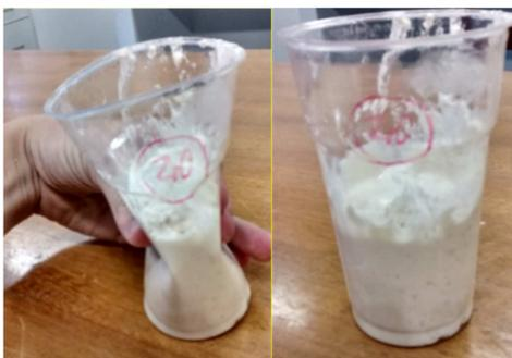
**Figura 25 – Espuma com proporção volumétrica de uma parte de resina para duas partes de emulsão**
