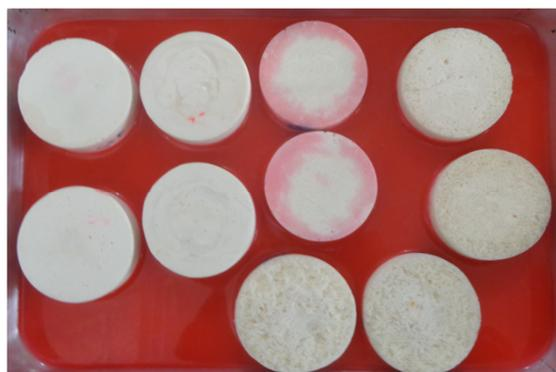
Figura 17 – Amostras submetidas ao ensaio de difusão por capilaridade
