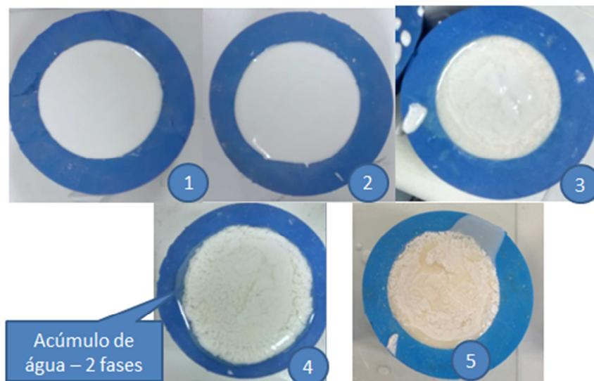
**Figura 28 – Espumas no início de processo de cura**
