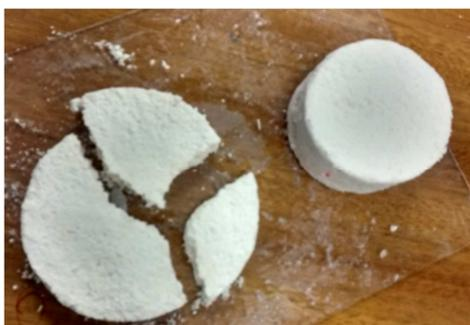
**Figura 26 – Espuma com proporção volumétrica de uma parte de resina para uma parte de emulsão**
