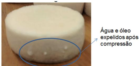
**Figura 29 – Espuma expelindo água e óleo após compressão**
