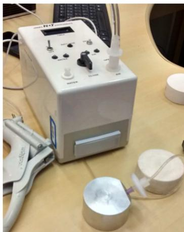
Figura 16 – Equipamento para medição de permeabilidade ao ar
