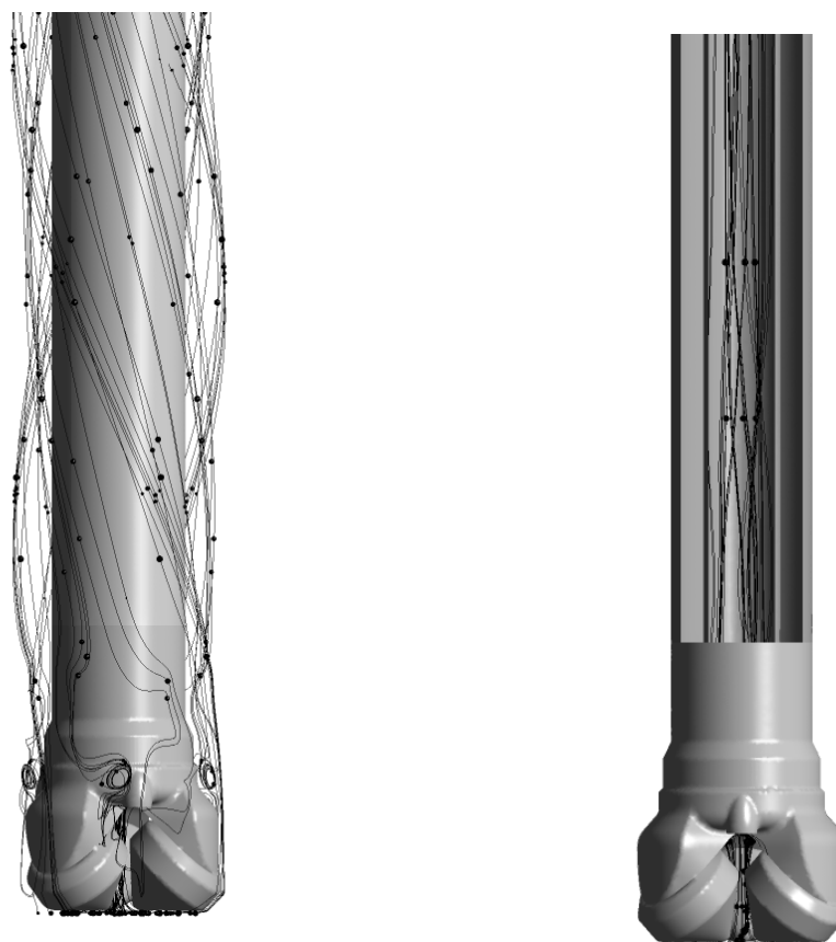
(a) Padrão de escoamento para a circulação direta. (b) Padrão de escoamento para a circulação reversa.
