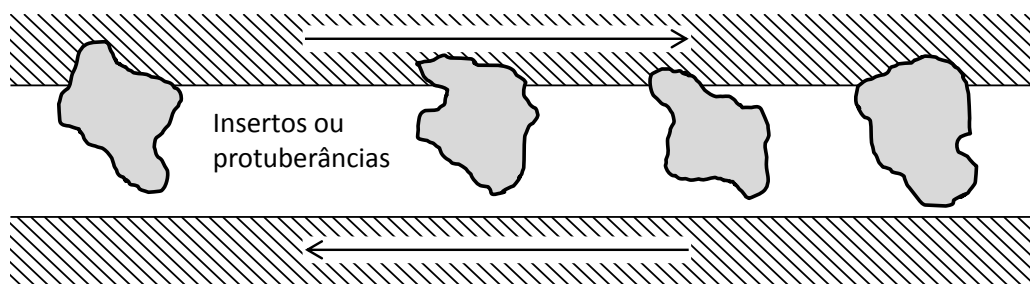
Figura 2.4 – Desgaste por abrasão a 2 corpos. Fonte: Adaptado de (HUTCHINGS, 1992)
