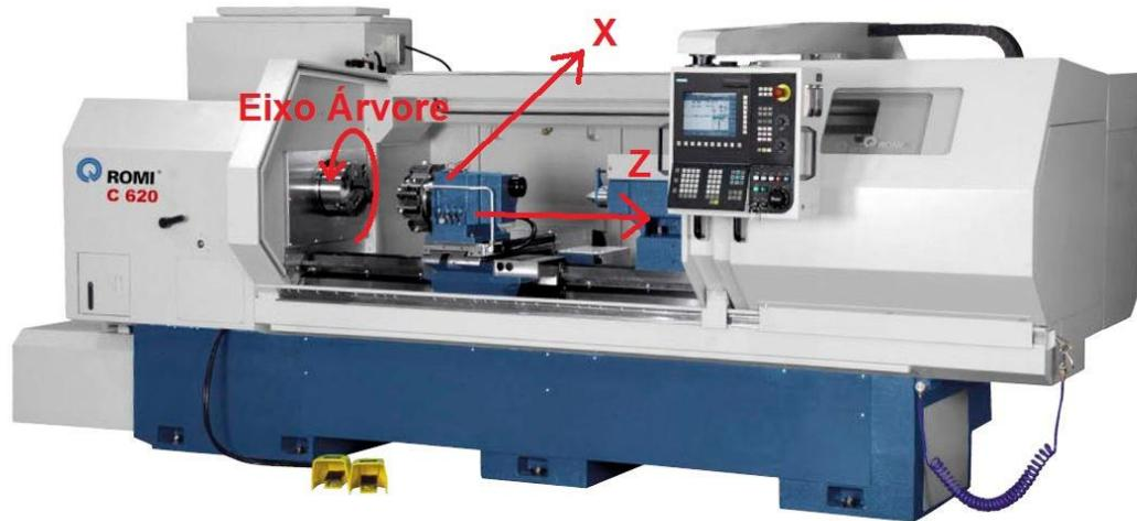
**Figura 1 - Identificação dos eixos em um torno CNC.**
