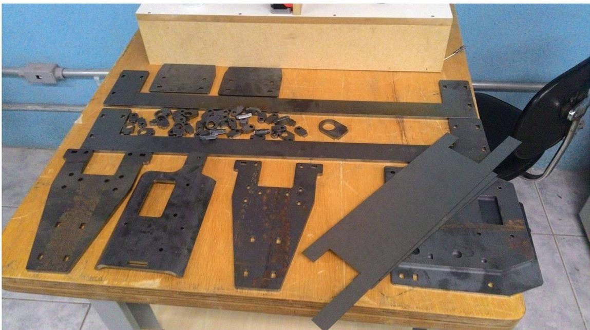
**Figura 22 - Componentes da máquina cortados a laser.**
