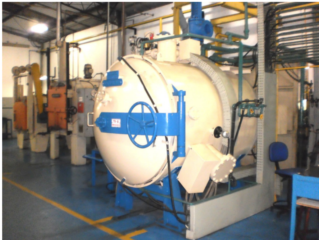
Figura 10 – Forno Brasimet TV6, utilizado no processo de têmpera a vácuo das amostras. Fonte: Autoria própria.
