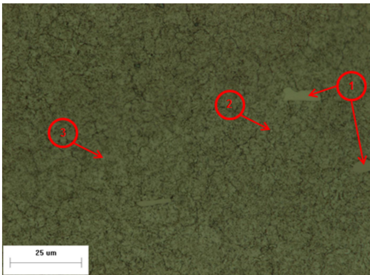
Figura 17 - Microestrutura do aço D2 modificado com 8% Cr no estado G1.3. Ataque com Superpicral.
