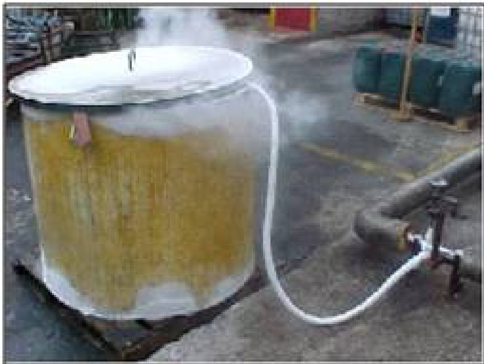
Figura 11 – Tanque de nitrogênio líquido puro, utilizado no processo de resfriamento criogênico realizado nas amostras.
