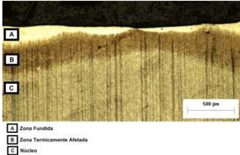
Figura 18- Microscopia ótica, amostra E1, ampliação 50X (Fonte: autoria própria).
