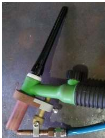
Figura 7 – Alimentador de gás independente (Fonte: autoria própria).
