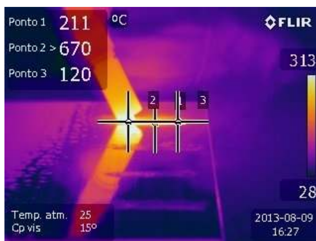
Figura 10 – Imagem fornecida pelo termovisor mostrando a distribuição de temperatura na amostra e as temperaturas em três pontos. (Fonte: autoria própria)
