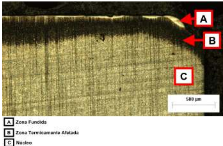
Figura 18- Microscopia ótica, amostra E1, ampliação 50X (Fonte: autoria própria).
