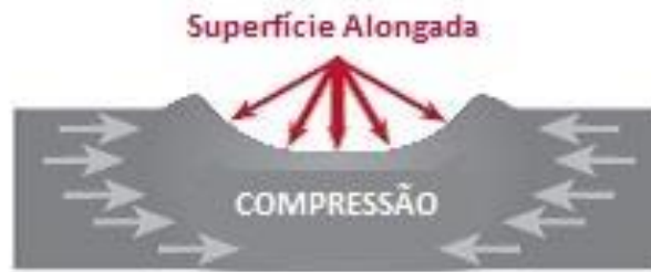
Figura 12 - Tensão residual compressiva gerada pelo jateamento
