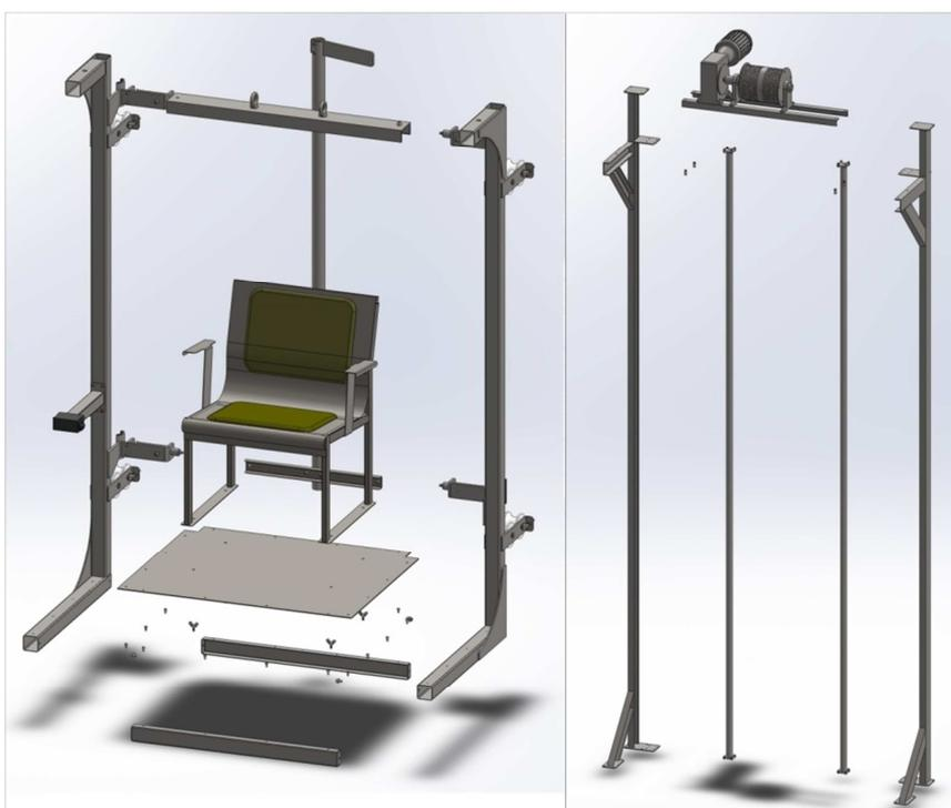
Figura 80. Conjunto cadeira elevatória explodido.
