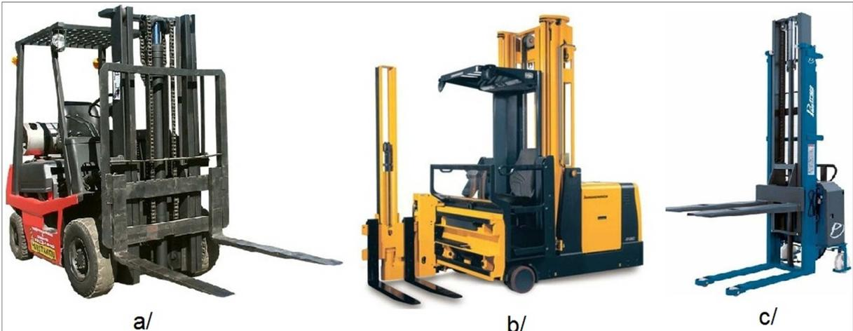
Figura 6. Exemplos de diferentes tipos de empilhadeiras. Adaptado de Webempilhadeiras (2010), Ztast Zanardo Treinamentos (2013) e Dutra (2013).
