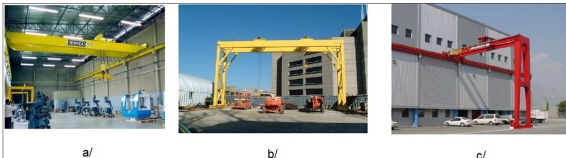
**Figura 8. Exemplos de ponte rolante (a) pórtico rolante (b) e semi-pórtico (c). Adaptado de Munck (2013) e Mollyn Equipamentos (2013).**
