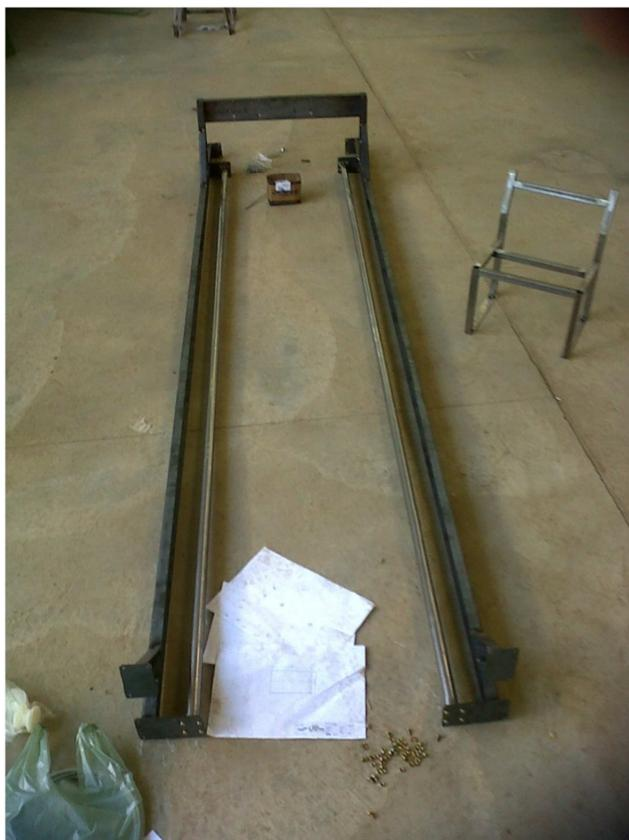
**Figura 88: Estrutura externa com os trilhos-guia e o suporte do motorreductor fixados.**
