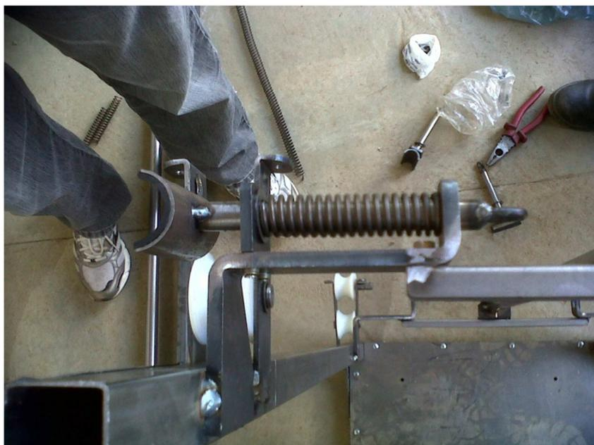
**Figura 91: Um dos sistemas de freio montados.**
