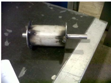
**Figura 86: Eixo e tambor fabricados.**
