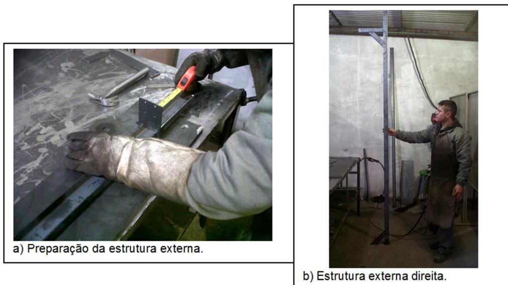
**Figura 85: Etapas da manufatura da extrutura externa.**
