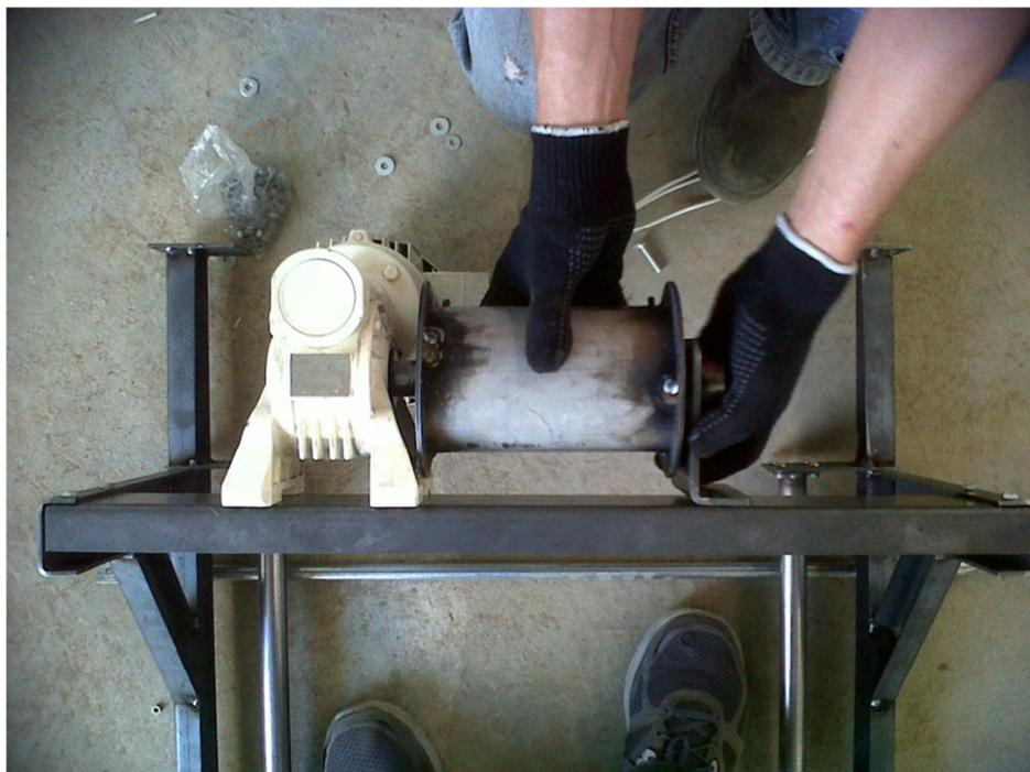
**Figura 89: Fixação do motorreductor no suporte.**
