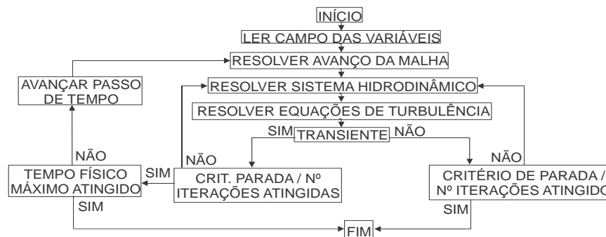
Figura 4.3 – Fluxograma simplificado da metodologia adotada pelo ANSYS CFX Release 13.0 para resolver o sistema de equações. (Fonte: Segala [2010], p. 47).
