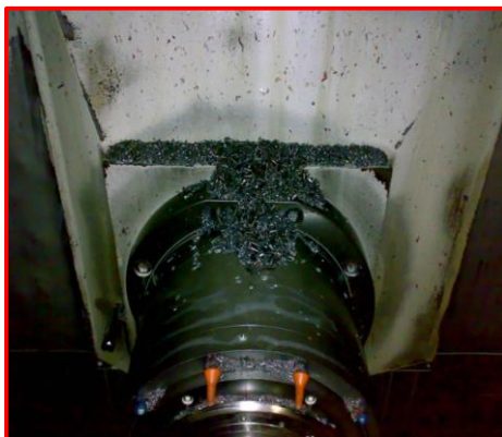
Figura 33 - Acumulo de cavaco no eixo árvore
