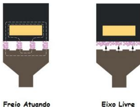
Figura 33 - Representação da atuação do pó magnético (LENZ, 2013)
