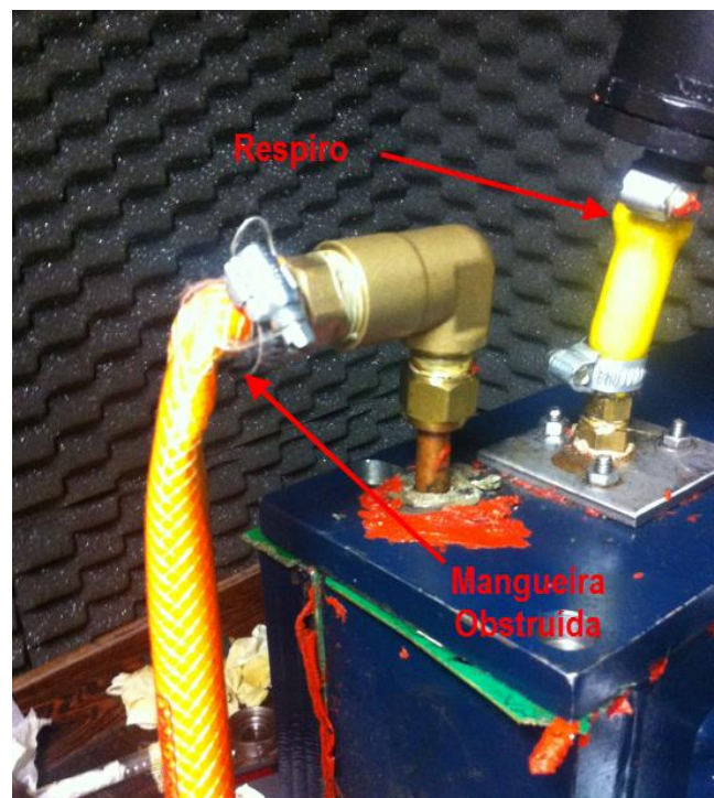
Figura 7 – Instalação da mangueira de arrefecimento do equipamento da UTFPR
