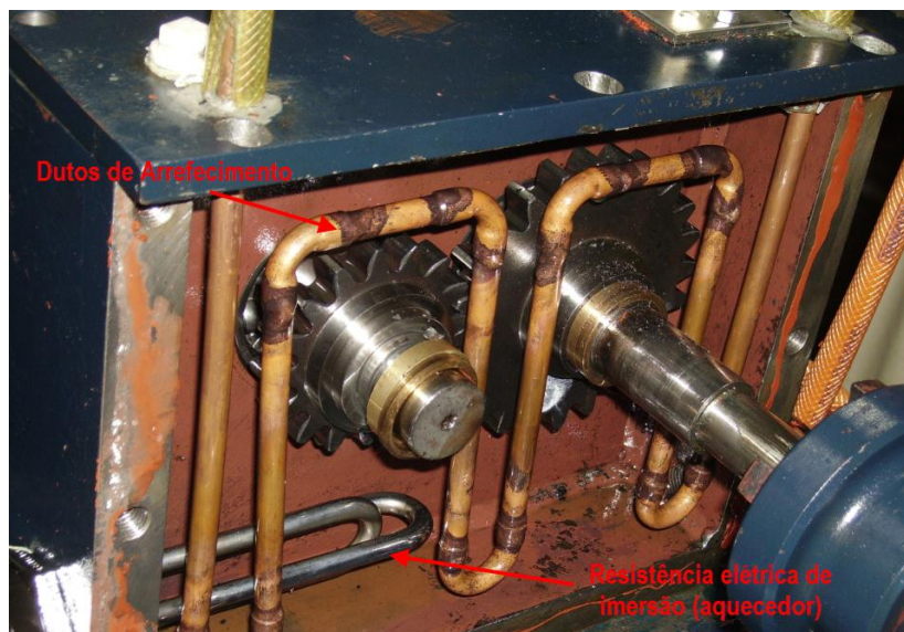
Figura 4 – Sistema de Arrefecimento X Aquecimento do equipamento FZG em uso na UTFPR (conceito Power Recirculation )
