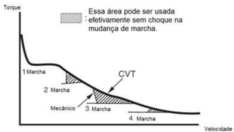
Figura 15 - Gráfico de Força x Velocidade na CVT Fonte: Adaptado de Chengyan (2010).
