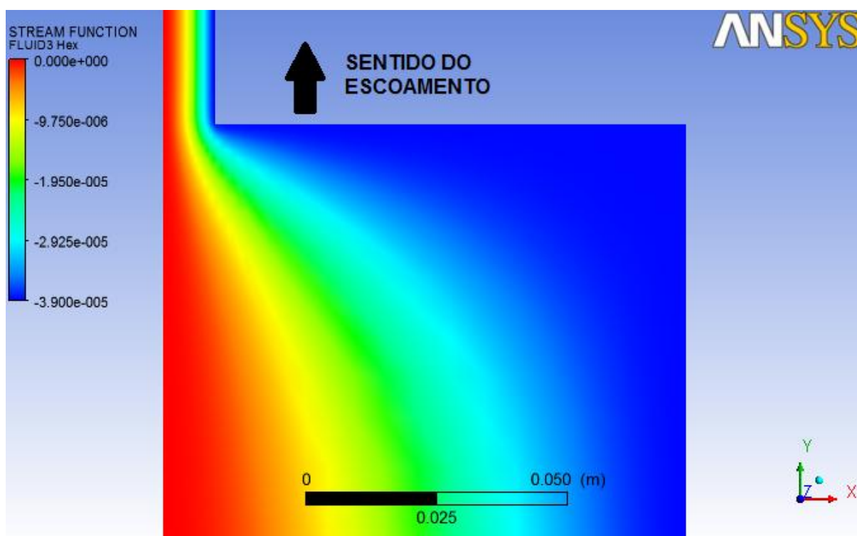
Figura 52 – HB-A: Linhas de corrente na contração ( \beta=10 e Re=100 )
