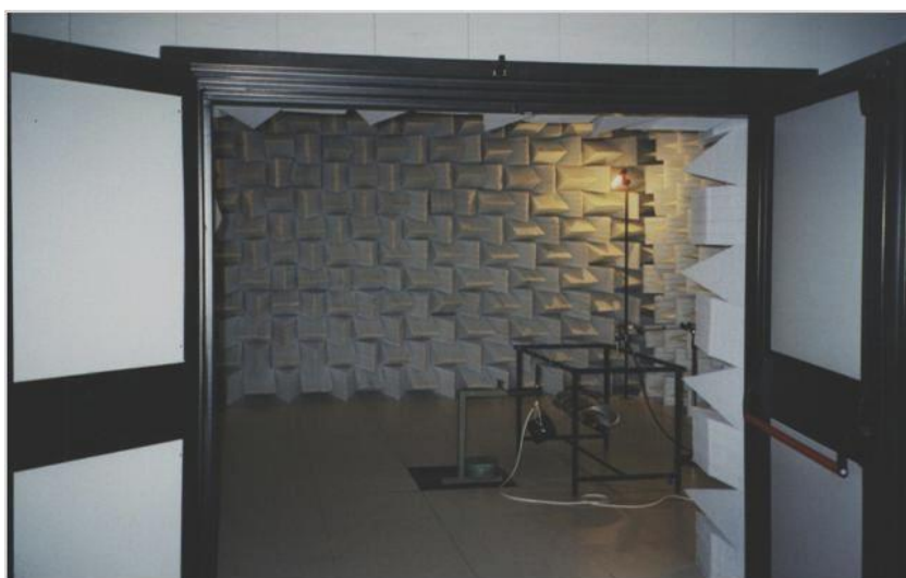
Figura 23 – Laboratório acústico com arranjo de racks
