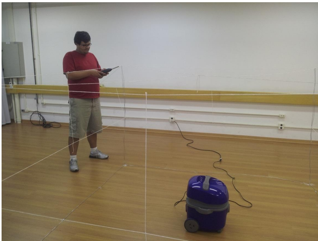
Figura 75 – Medição do nível de pressão sonora
