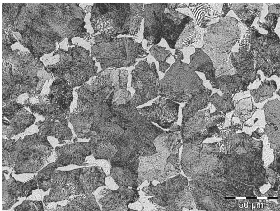
**Figura 12 - Microestrutura do estado de fornecimento (ataque de nital 2%)**
