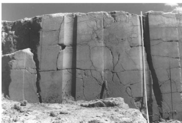
**Figura 1.1. Foto de uma rocha arenítica fraturada.**
