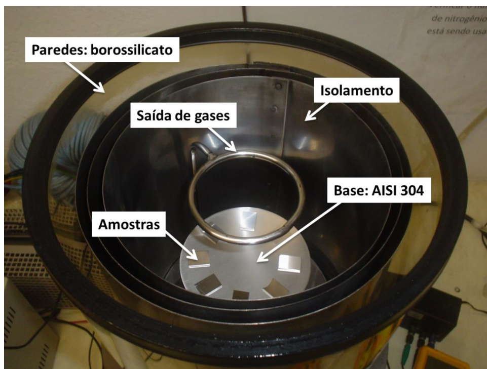
Figura 12 – Posicionamento das amostras no reator de plasma sobre a base de AISI 304 e abaixo da saída de gases.
