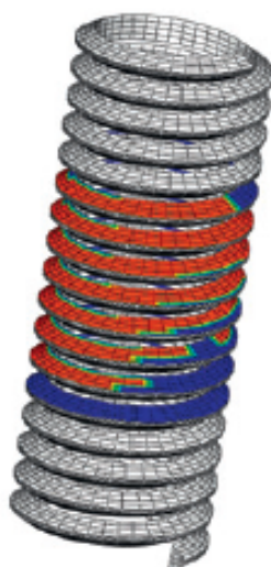
Figura 5-Análise de rosca pelo método dos elementos finitos
