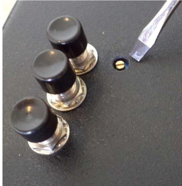
Figura2–Trimpot de ajuste de início de ensaio Fonte:Autoria Própria
