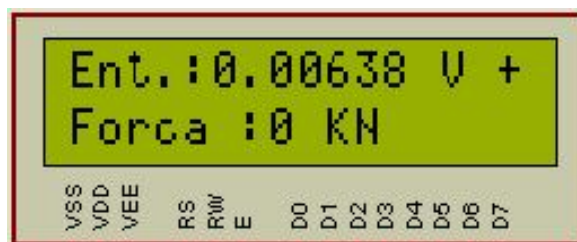
Figura3–Display para visualização dos resultados de ensaio Fonte:Autoria Própria
