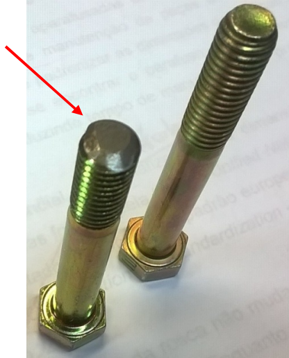
Figura 8 – Amostra preparada para ensaio de perfilometria
