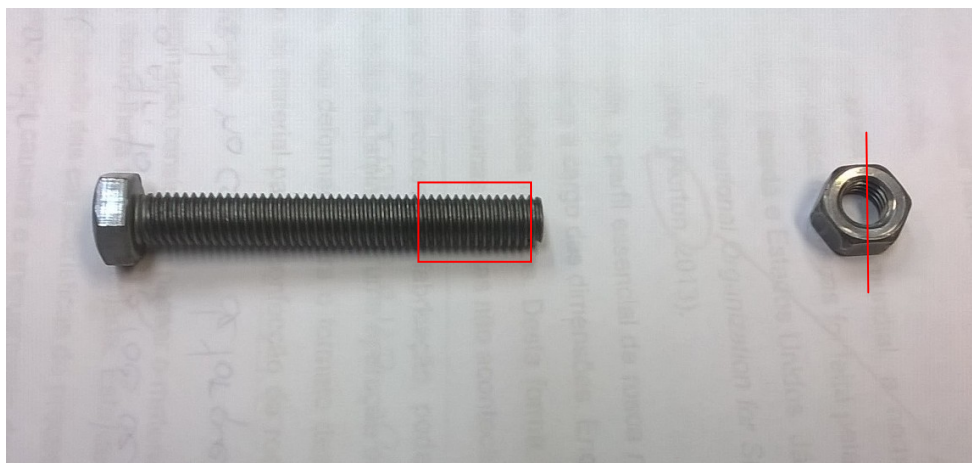
Figura 7 – Região dos cortes para preparação das amostras.
