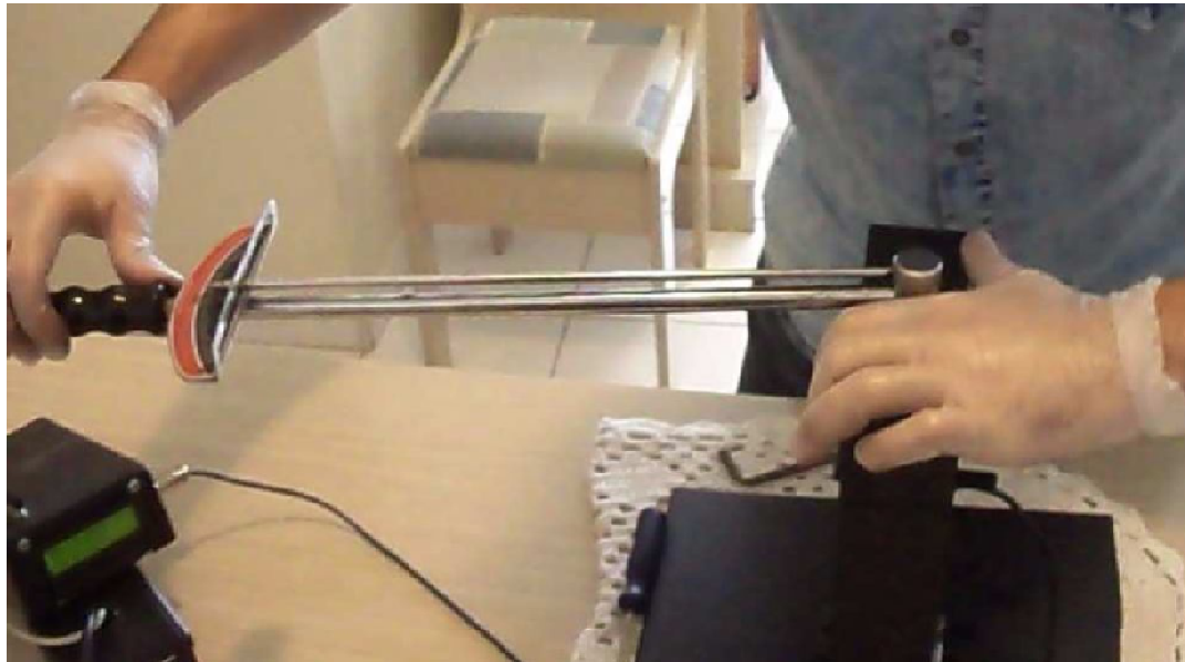
Figura4–Aplicando o torque ao conjunto de ensaio Fonte: Autoria Própria
