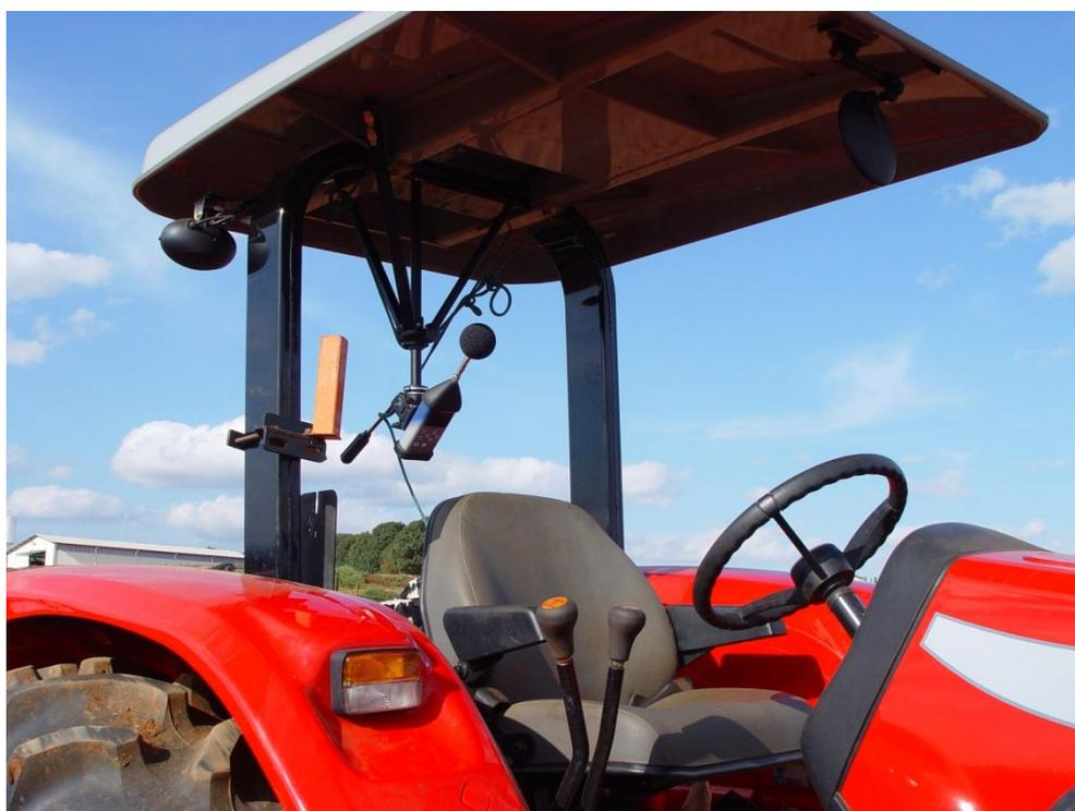
**Figura 12 – Fixação do equipamento de análise nos tratores**
