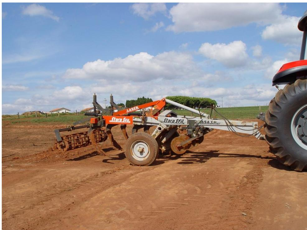
**Figura 13 – Arado utilizado no processo de medição em movimento com carga**
