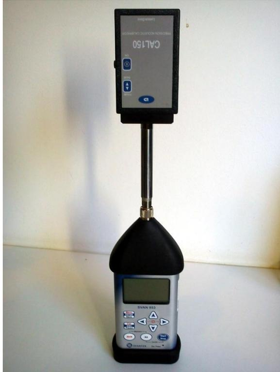
Figura 5 – CAL 150 Acoplado ao Svan 953
