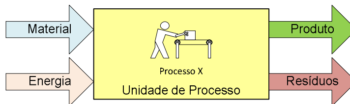
Figura 2 – Esquema de uma unidade de processo mostrando as entradas e saídas de energia ou material
