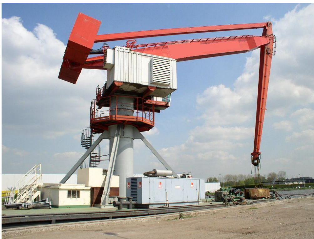
Figura 1.1.1 – Guindaste portuário flutuante para elevação de carga
