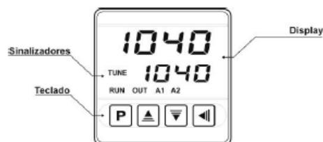
Fig. 02 - Identificação das partes do painel frontal
