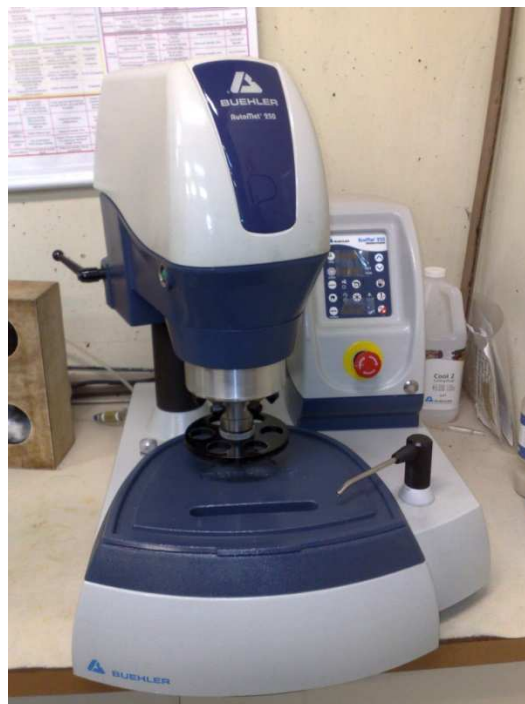
Figura 13 - Politriz automática Buehler EcoMet 250 – Laboratório de Materiais UTFPR
