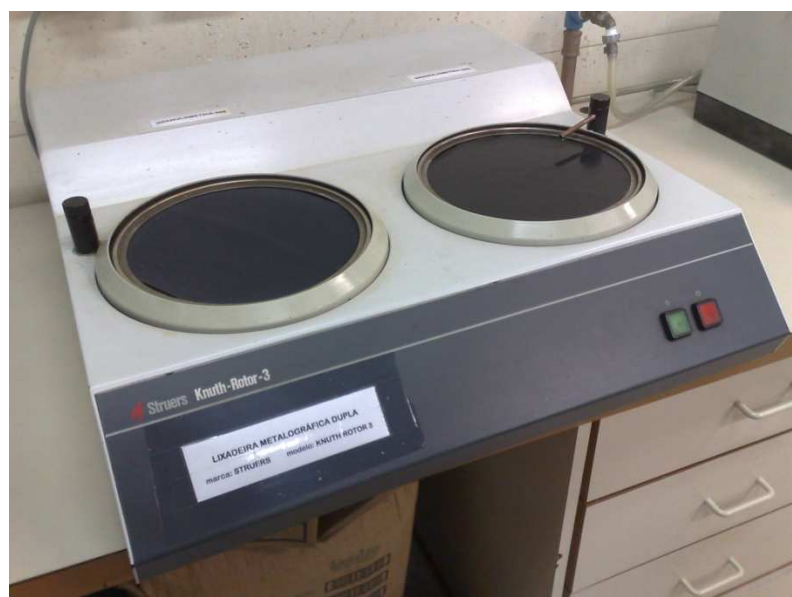
Figura 12 - Lixadeira Struers Knuth Rotor 3 – Laboratório de Materiais UTFPR
