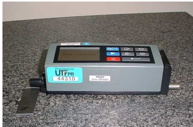
Figura 14 - Rugosímetro Instrutherm RP 200
