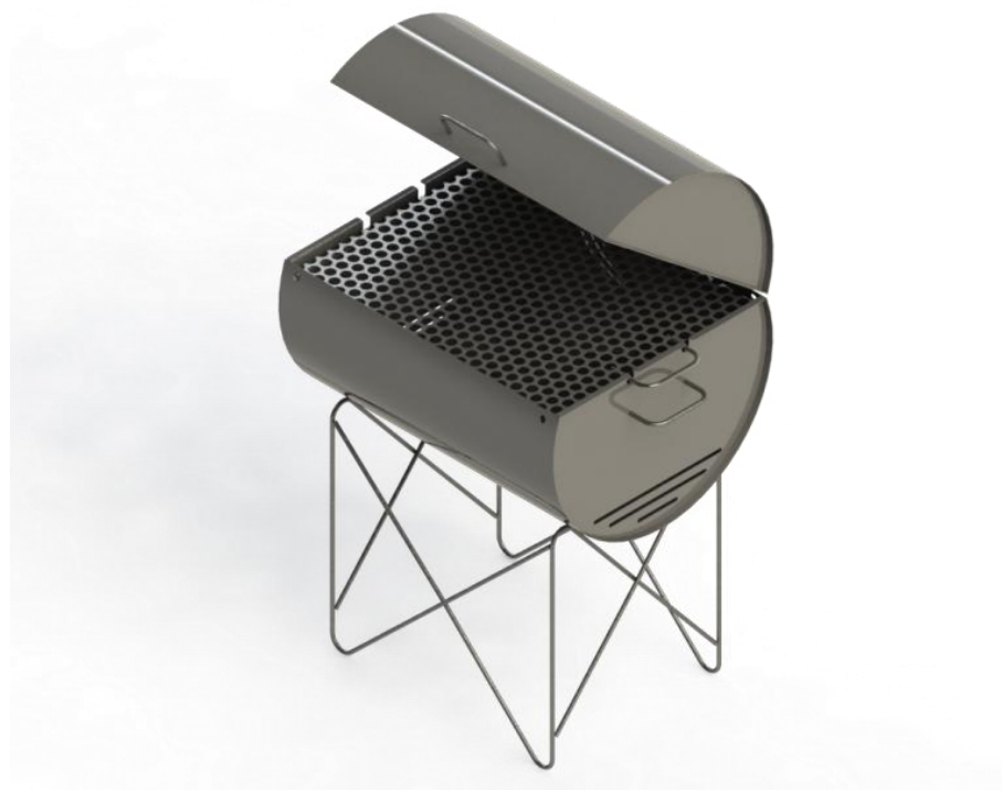
Figura 26 – Projeto da churrasqueira de tambor utilizada no experimento
