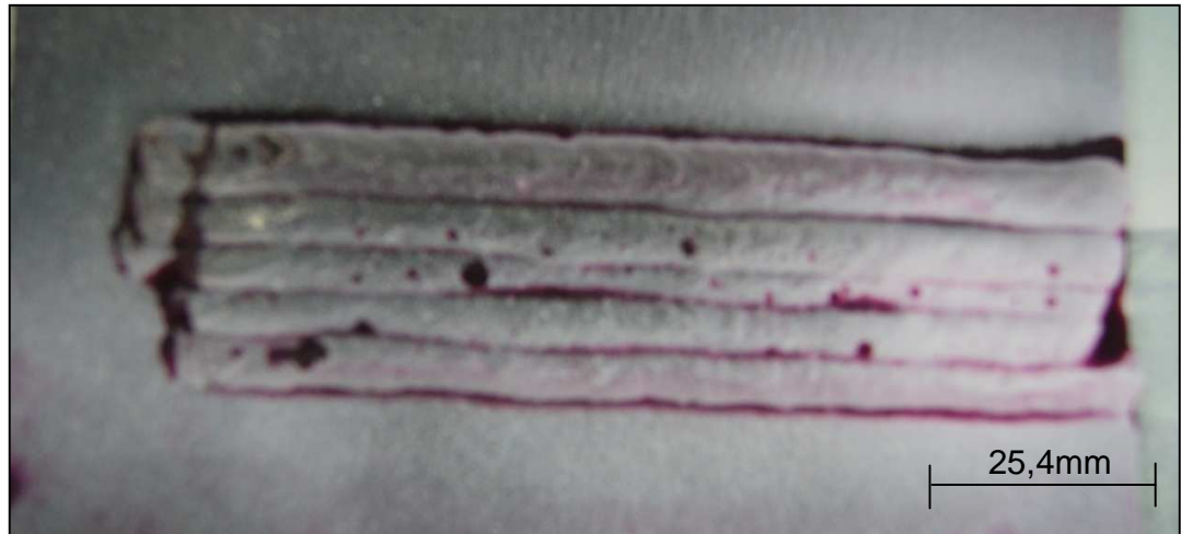
Figura 29 – Corpo de prova com pré-aquecimento a 350°C
