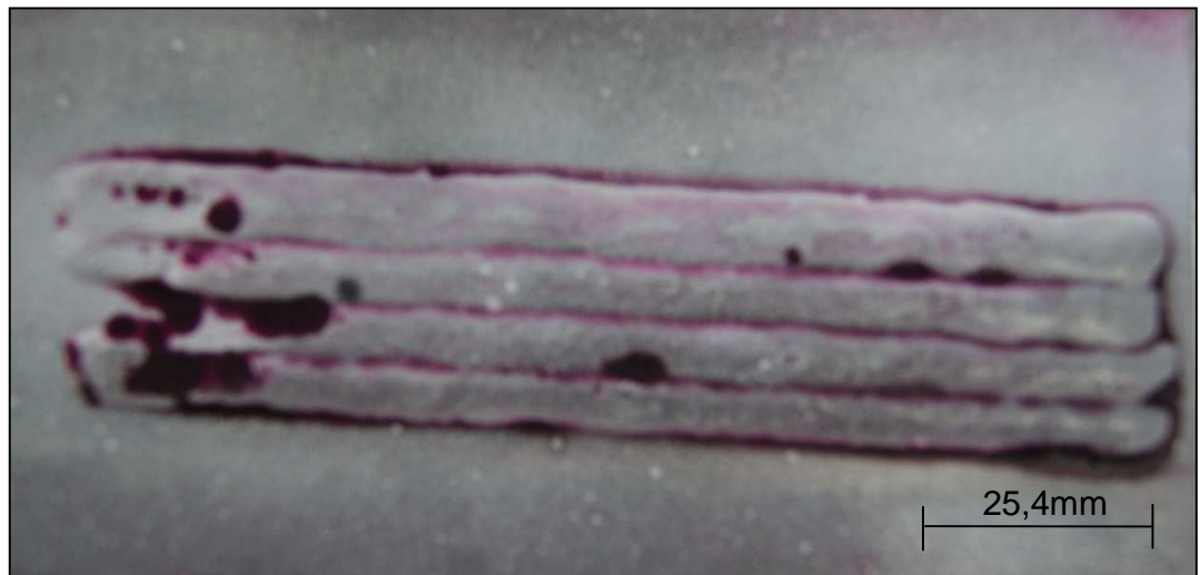
Figura 30 – Corpo de prova com pré-aquecimento a 450°C
