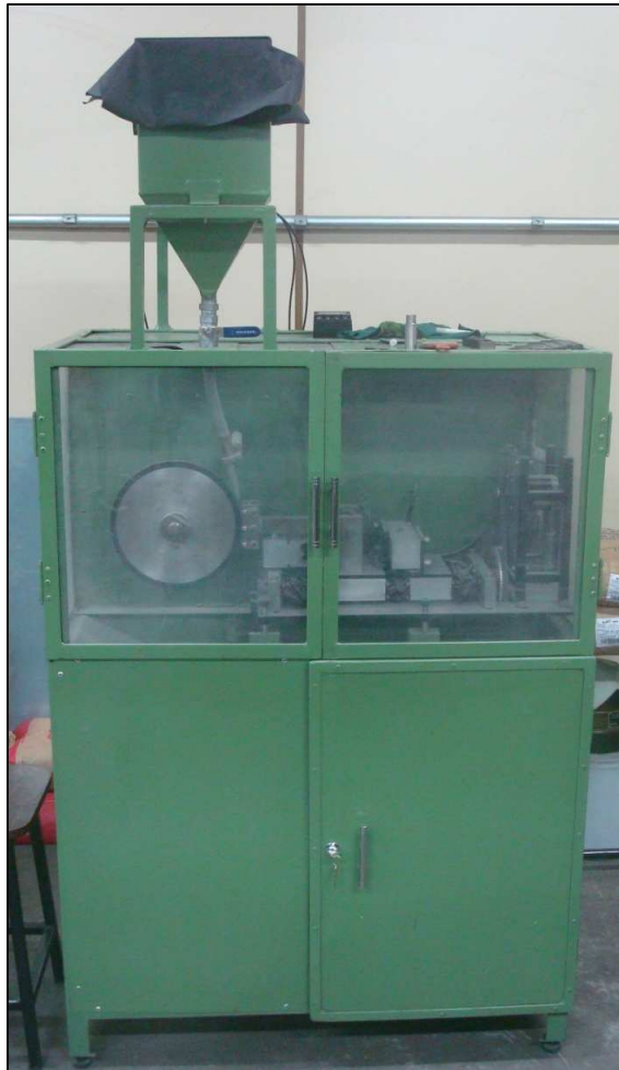
Figura 24 - Abrasômetro de roda de borracha utilizado para os ensaios
