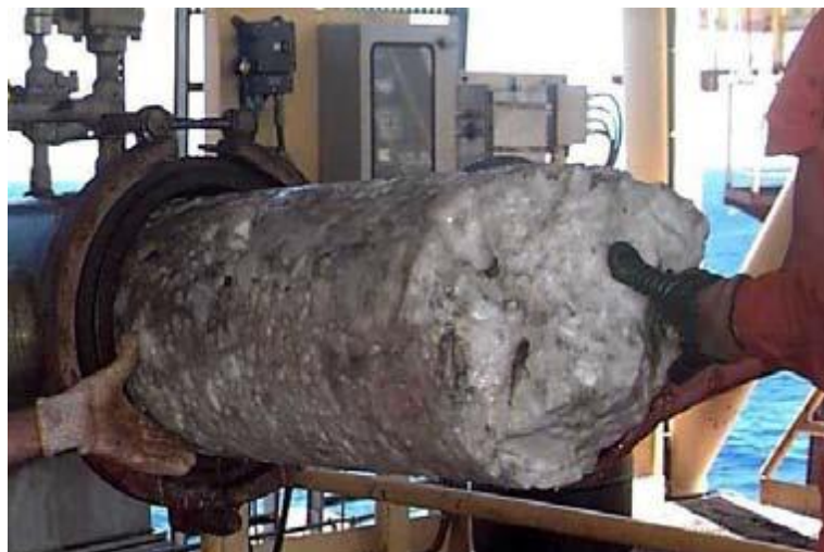
Figura 1.3 – Bloqueio de duto por formação de hidratos Fonte: Arquivo da Petrobras
