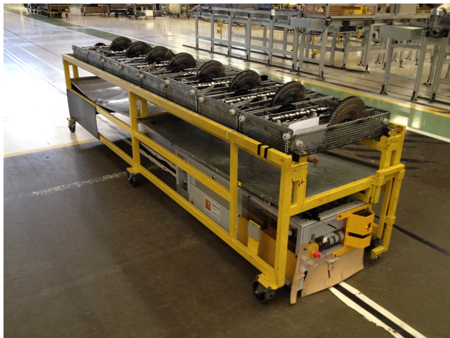
Figura 19: Transportador AGV com carrinho contendo 08 kits Fonte: Empresa estudada
