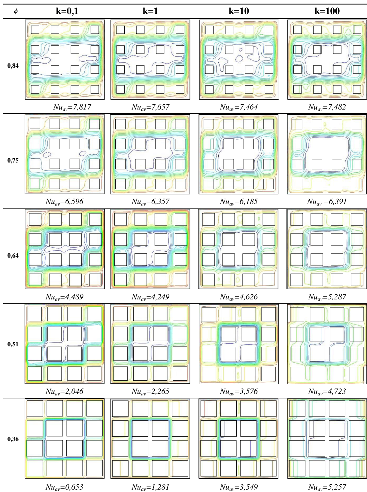
Figura 5.18 – Linhas de corrente para variação de k e \Phi . N=16 e Ra=10^6 .
