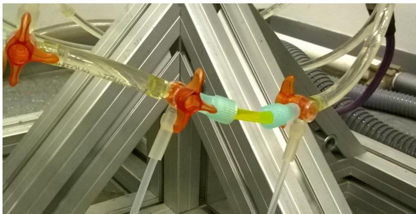
**Figura 24 – Sistema de válvulas três-vias.**
