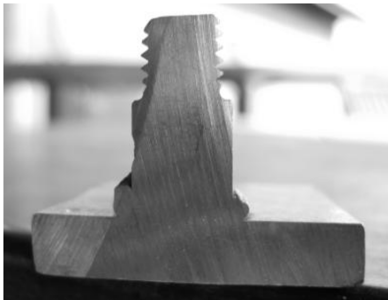
Figura 30 – Seção longitudinal de um pino soldado.
