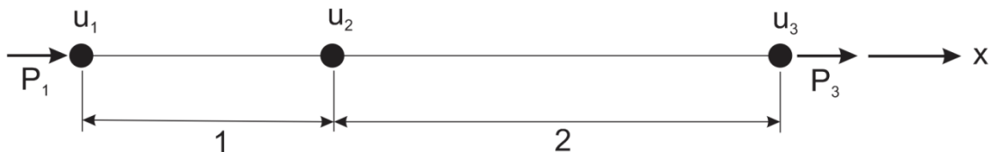
Figura 19 – Malha de elementos de barra.
