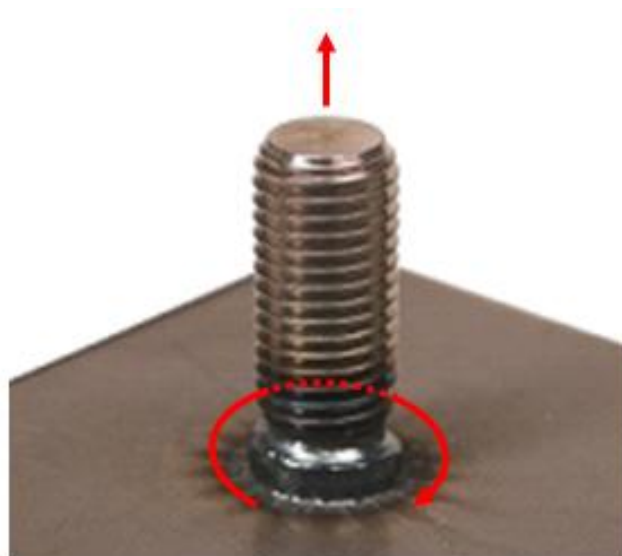
Figura 29 – Representação do diagrama de corpo livre do pino soldado.
