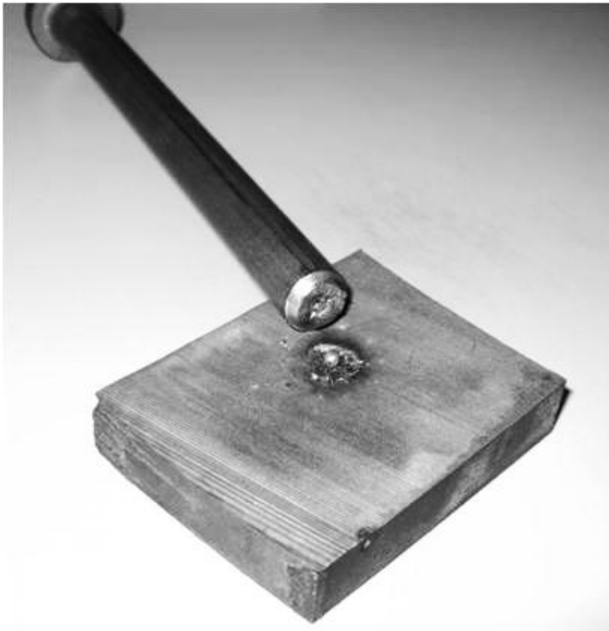
Figura 28 – Pino com solda inadequada.
