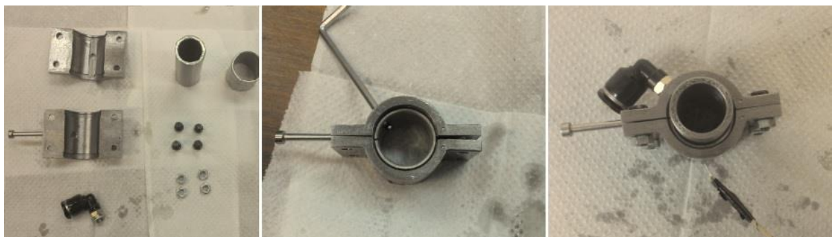
Fotografia 10: Estágios da montagem do SCP. (a) Conjunto desmontado, (b) União as duas semi-montagens, (c) conjunto completo.
