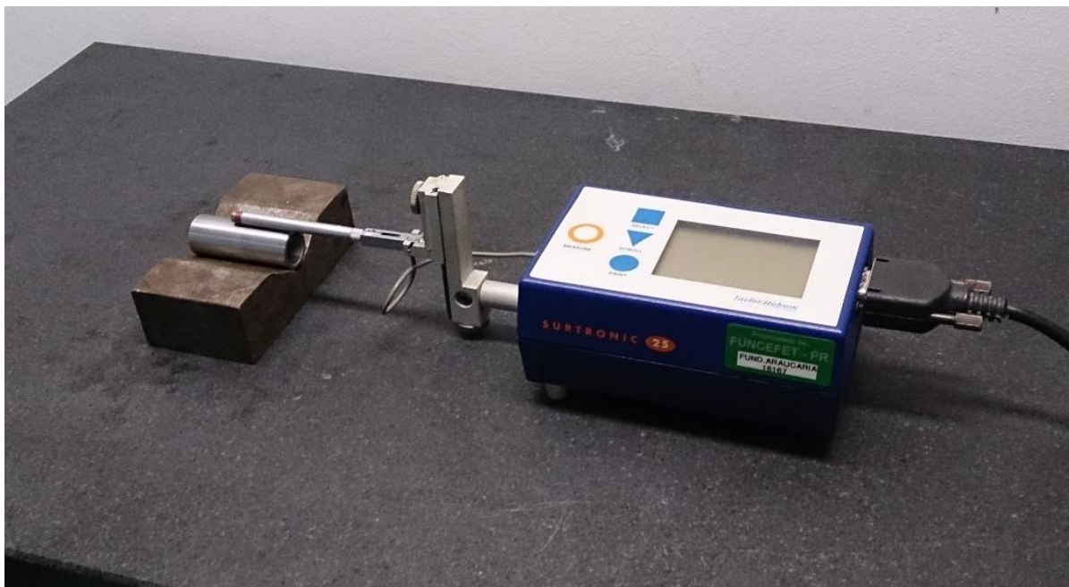
Fotografia 7: Análise de um CCP no rugosímetro sobre o desempenho.
