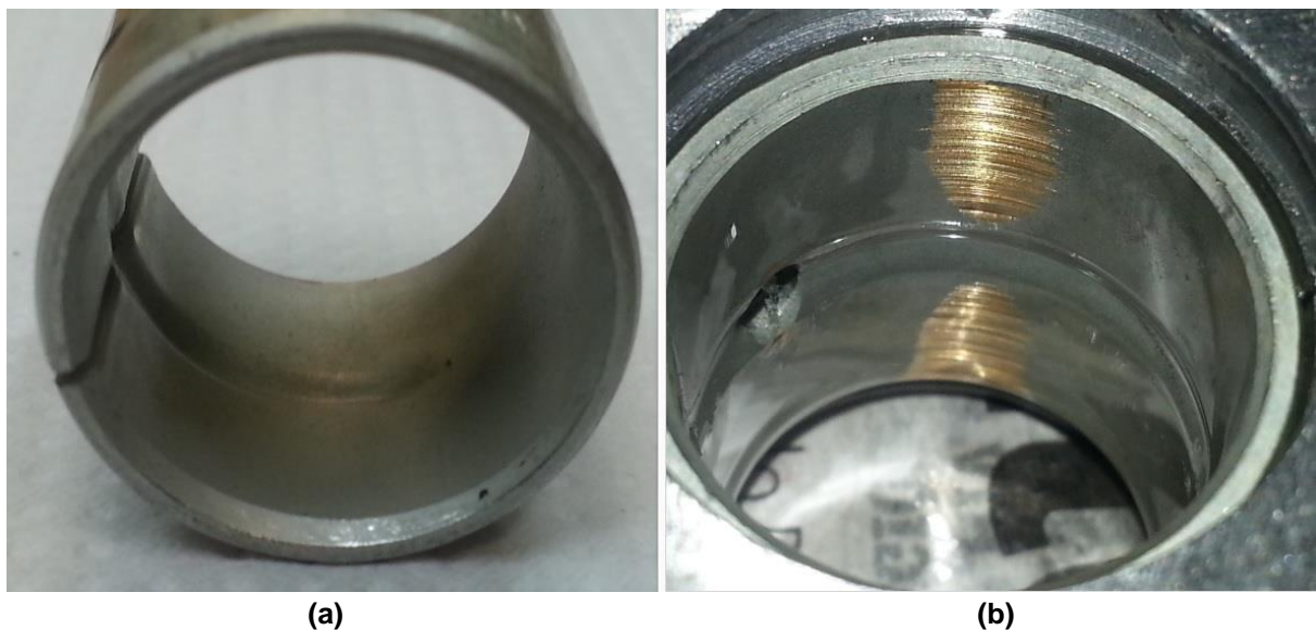
Fotografia 8: Diferença entre o aspecto visual do corpo de prova antes (a) e depois (b) dos ensaios.
