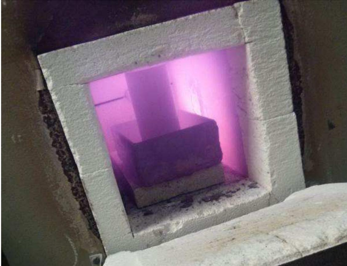
**Figura 14 - Banho de TRD sendo preparado no Laboratório de Materiais da UTFPR.
