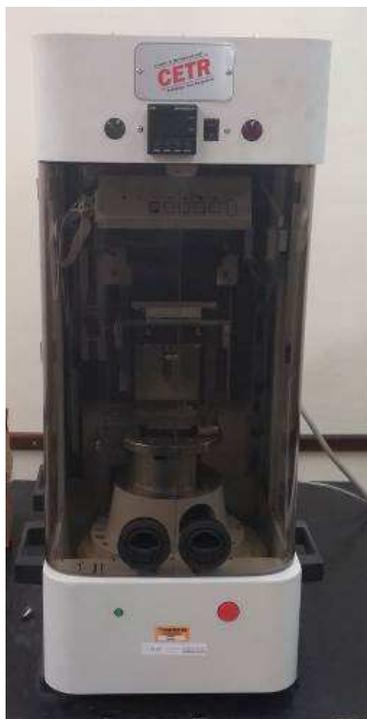
Figura 16 - Tribômetro utilizado para a realização dos ensaios. Fonte: Autoria própria
