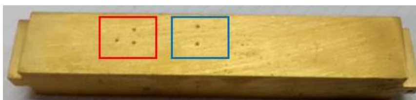
Figura 27 – Marcações realizadas para identificação: do número da amostra, em vermelho; e do grupo de rugosidade em azul
