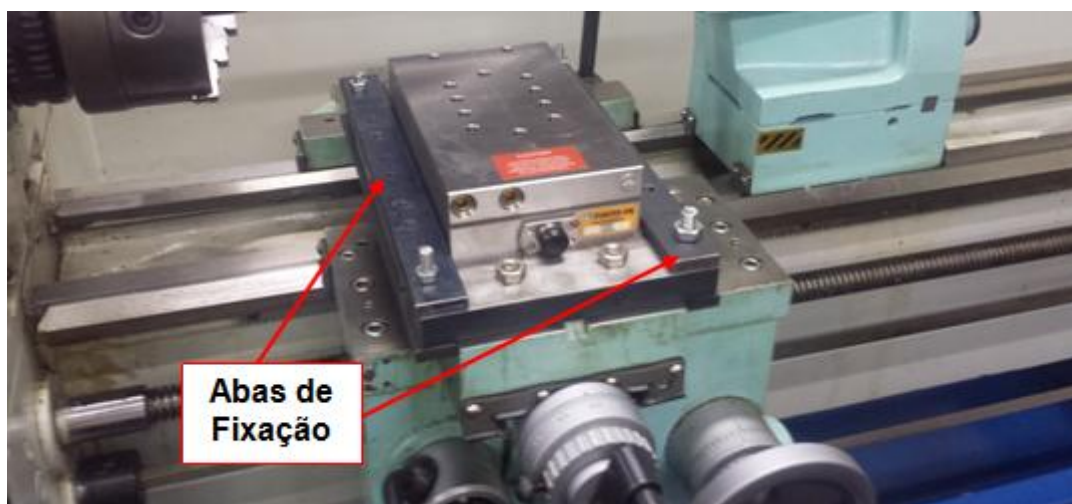
Figura 42 – Os demais componentes do suporte de fixação da plataforma montados, restringindo-a em todos os sentidos de movimento
