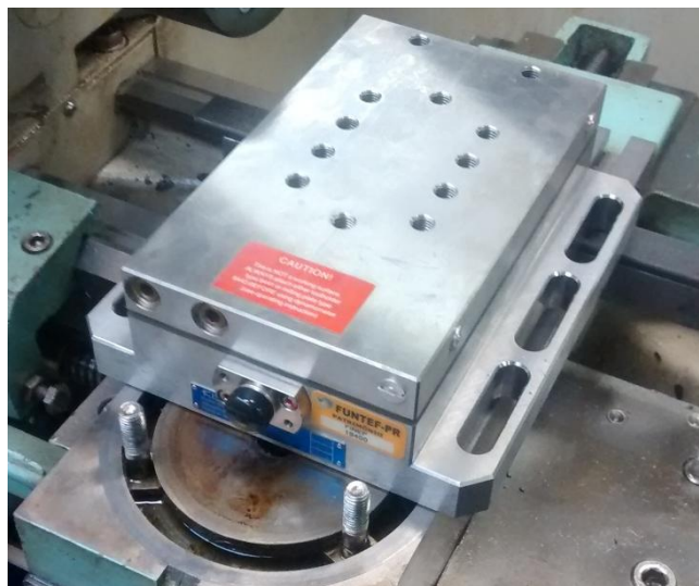
Figura 40 – Posição das abas da plataforma em relação ao carro transversal do torno
