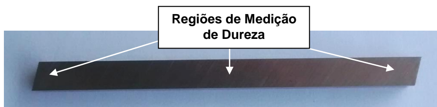
Figura 20 – Bits de aço rápido M2 e regiões de medição de dureza
