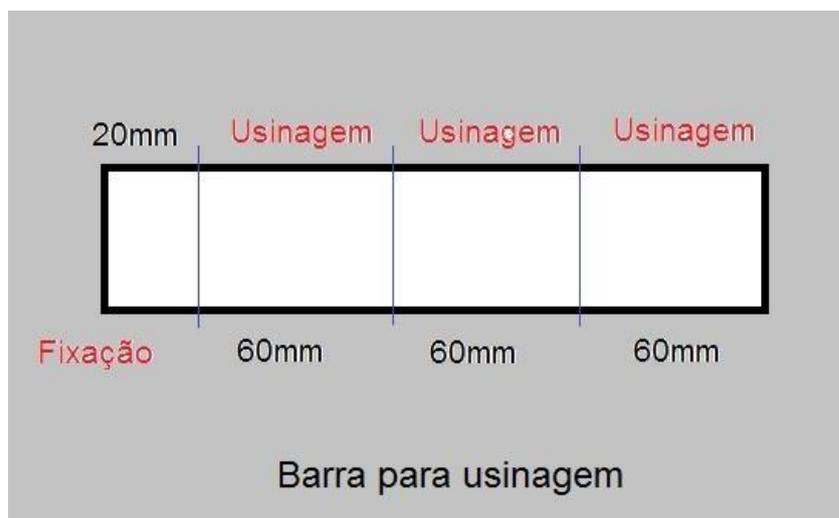
**Figura 13 - Barra para usinagem**
