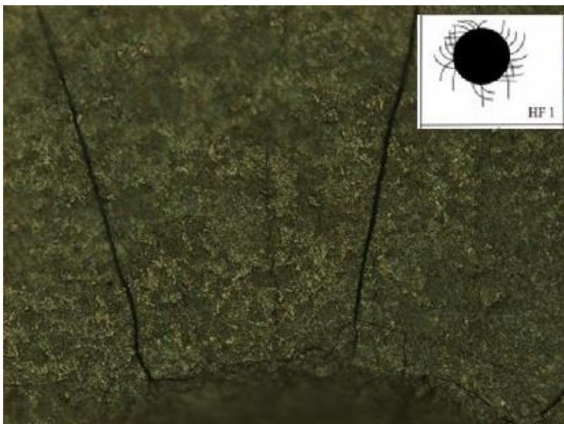
**Figura 22 - Indentação de 100 kgf para o aço AISI D2 submetido a tratamento de boretação**
