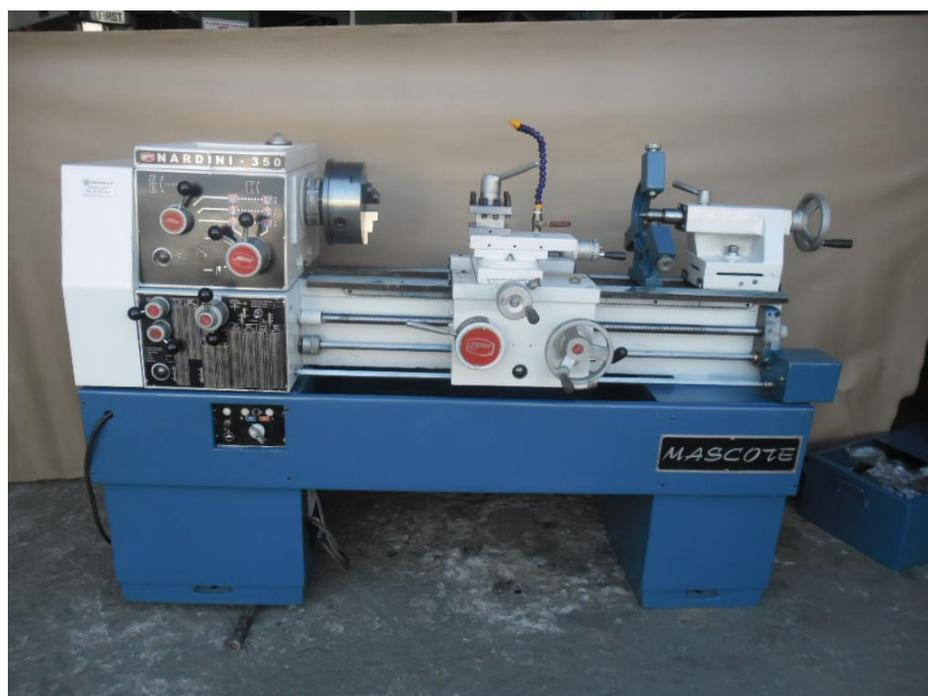
**Figura 12 – Torno mecânico da marca Nardini, modelo MS 205, para realização dos testes de usinagem.**
