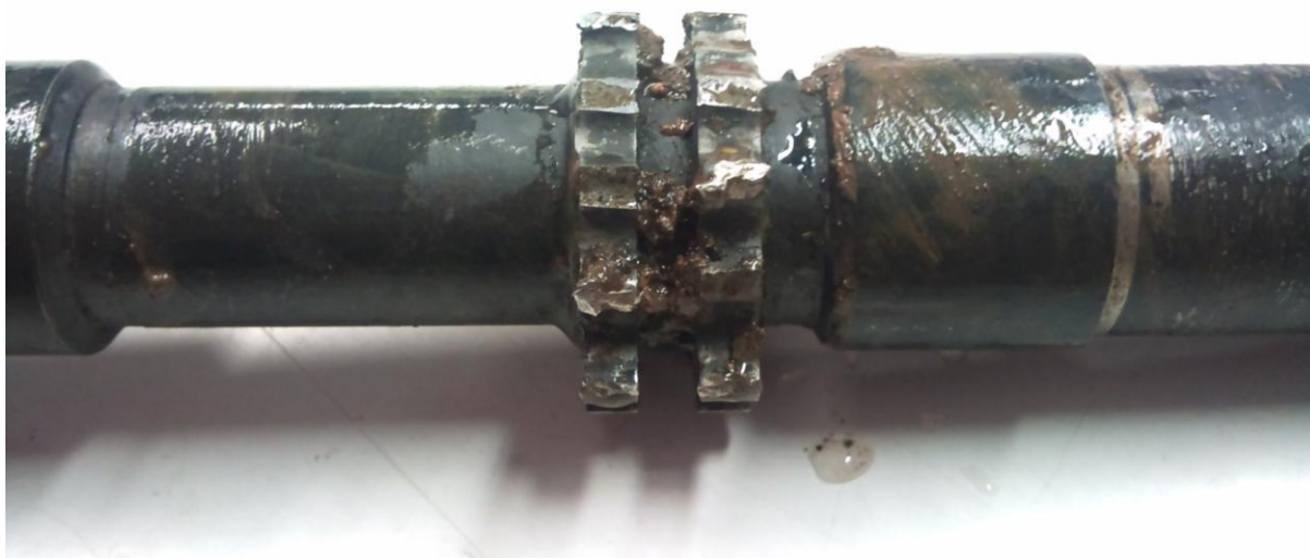
Figura 34 – Fratura dos dentes do pinhão - Baja SAE Brasil 2011.
