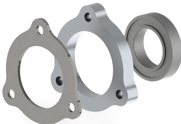
Figura 29 – Vista explodida do mancal feito a partir de chapas de alumínio.
