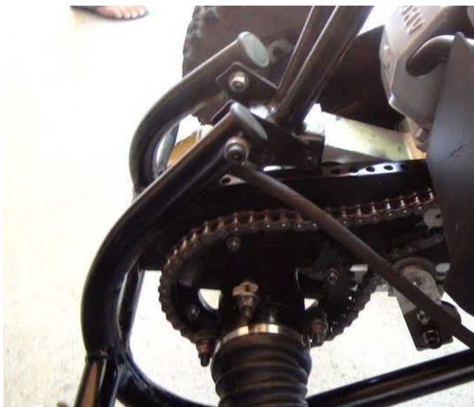
Figura 12 – Fotografia do sistema de redução aberto utilizado pela equipe UFPBaja em 2013.
