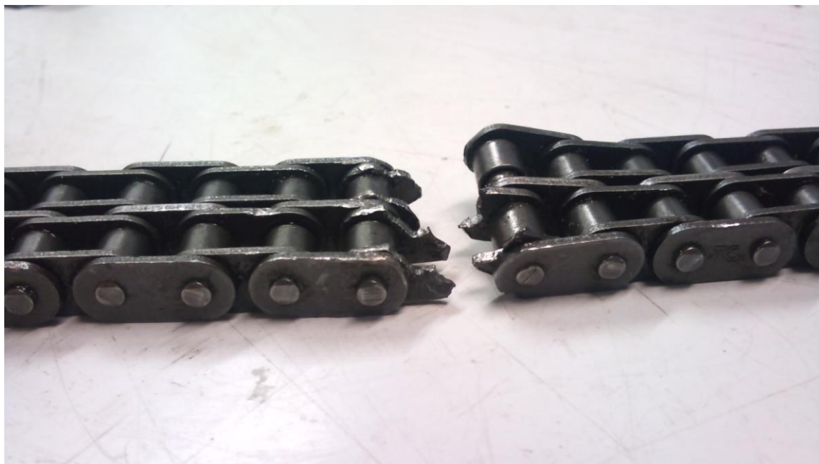
Figura 35 – Corrente rompida - Testes para Baja SAE Brasil 2012.
