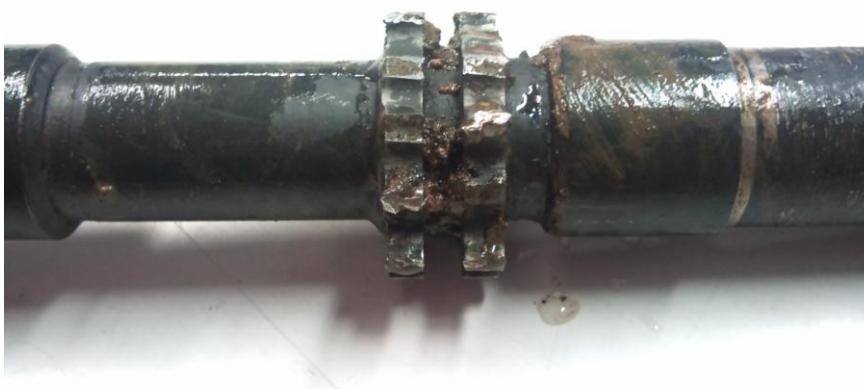
Figura 3 – Fratura dos dentes do pinhão – Baja SAE Brasil 2011.
