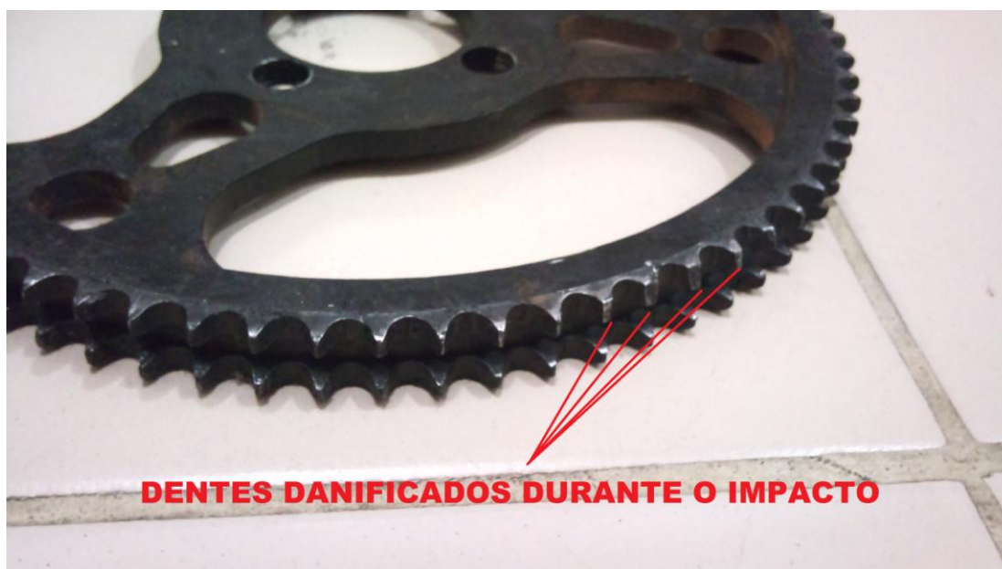
Figura 36 – Falha nos dentes da coroa - Testes para Baja SAE Brasil 2012.
