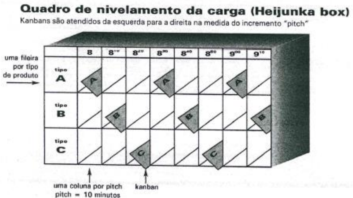
Figura 13 Quadro de nivelamento de carga
